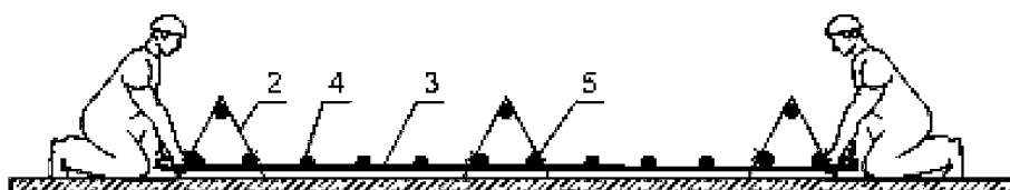
Установка каркасов поддерживающих верхнюю сетку
