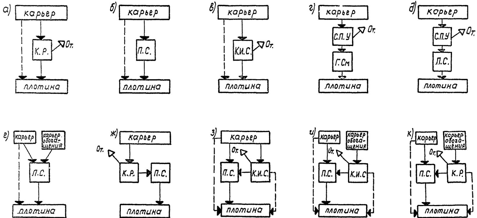
Рис.3.1. Технологические схемы кондиционирования карьерных грунтов для возведения грунтовых плотин.
