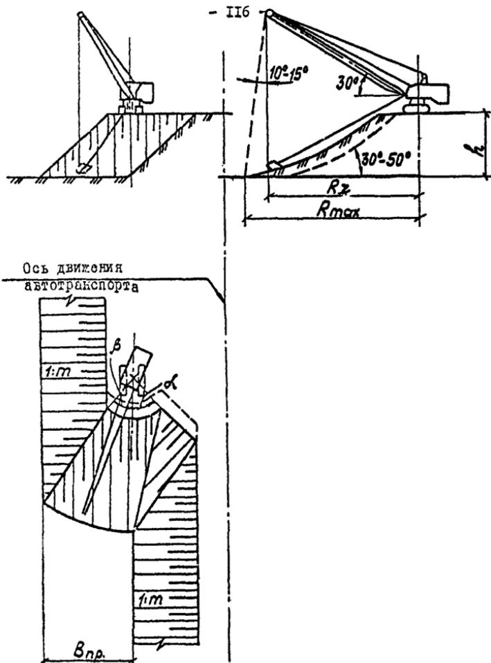
Рис. П.2.4. Схема разработки грунтов экскаватором-драглайном с закидкой ковша.
