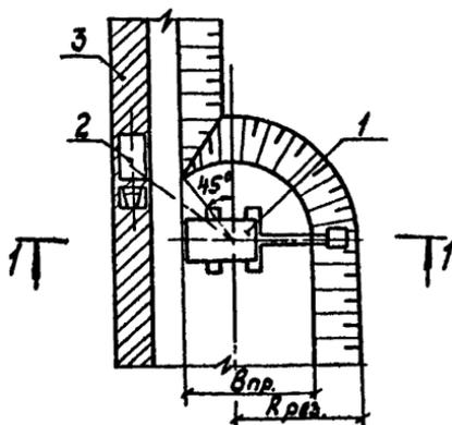
Рис. П.2.3. Схема разработки грунтов экскаватором боковым забоем.
