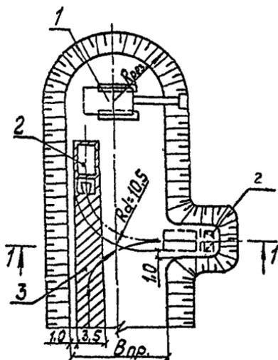
Рис. П.2.2. Схема разработки грунтов экскаватором лобовым забоем.
