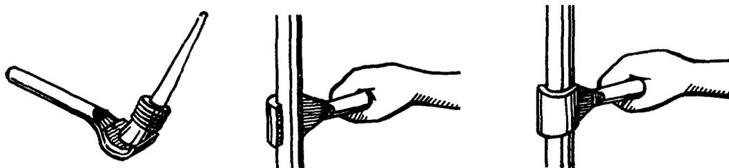
С помощью кисти маляр наносит на вогнутую (оклеенную мехом) поверхность приспособления олифу. Затем смоченное олифой приспособление маляр заводит в промежуток между стеной и трубой и движениями вверх и вниз олифит трубу со всех сторон
