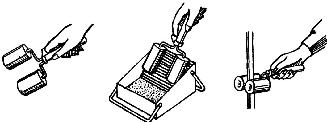
Маляр, нажав большим пальцем руки на рычаг, раздвигает валики, а затем набирает на них олифу. Для этого он прокатывает валики по сетке, установленной в ванночке с олифой. После чего маляр надвигает валики в раздвинутом положении на стержень или трубу и опускает рычаг. Валики, сдвигаясь, плотно обжимают обрабатываемую поверхность стержня (трубы). Движением вверх-вниз маляр олифит поверхность трубы или стержня
