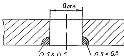
3. Для галтельных переходов поверхностная трещина (см. эскиз)
