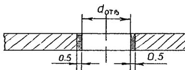
2. Для толстых листов, плит, пластин четвертькруговые угловые трещины с двух сторон отверстия (см. эскиз)
