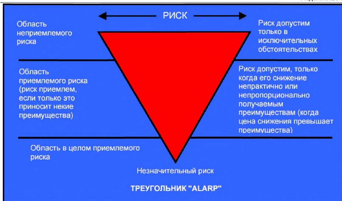
Рис. 4.5.2–2. Порядок принятия управленческих решений в соответствии с концепцией ALARP
