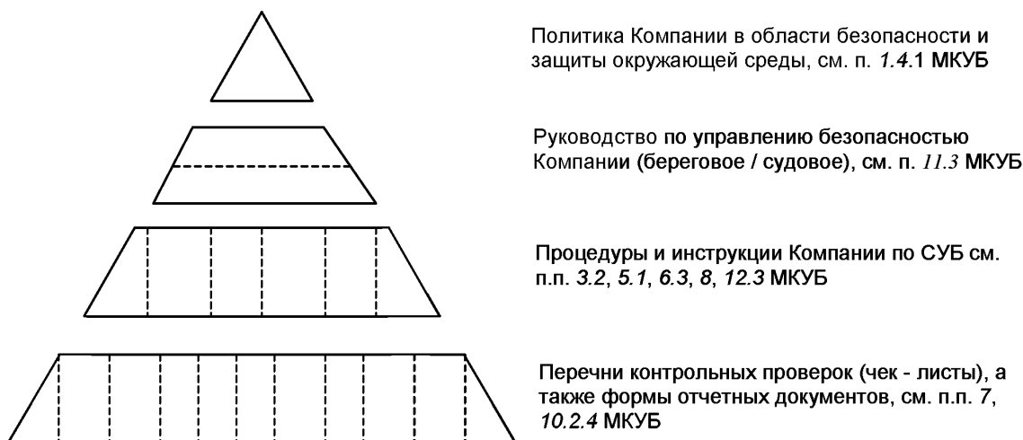
Рисунок 1.4. Примерная структура документации СУБ
