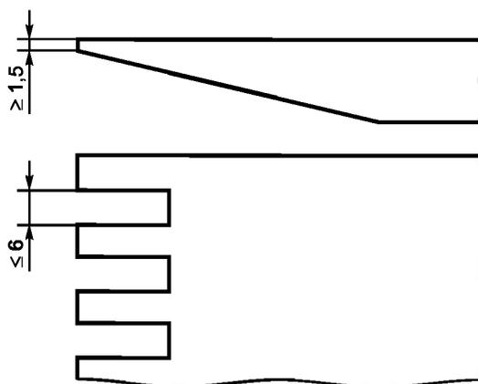
Рисунок 4 — Пример — кромки стола с пазами
