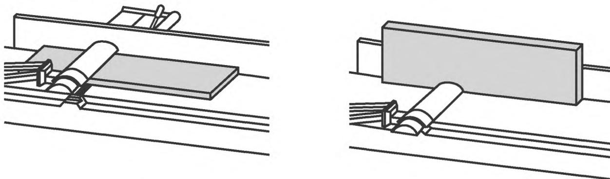
Рисунок 2 — Фугование плоскости (слева) и кромки (справа)
