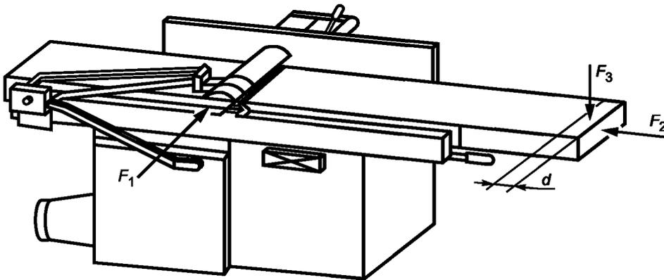
Рисунок С.1 — Испытание на устойчивость передвижных станков
