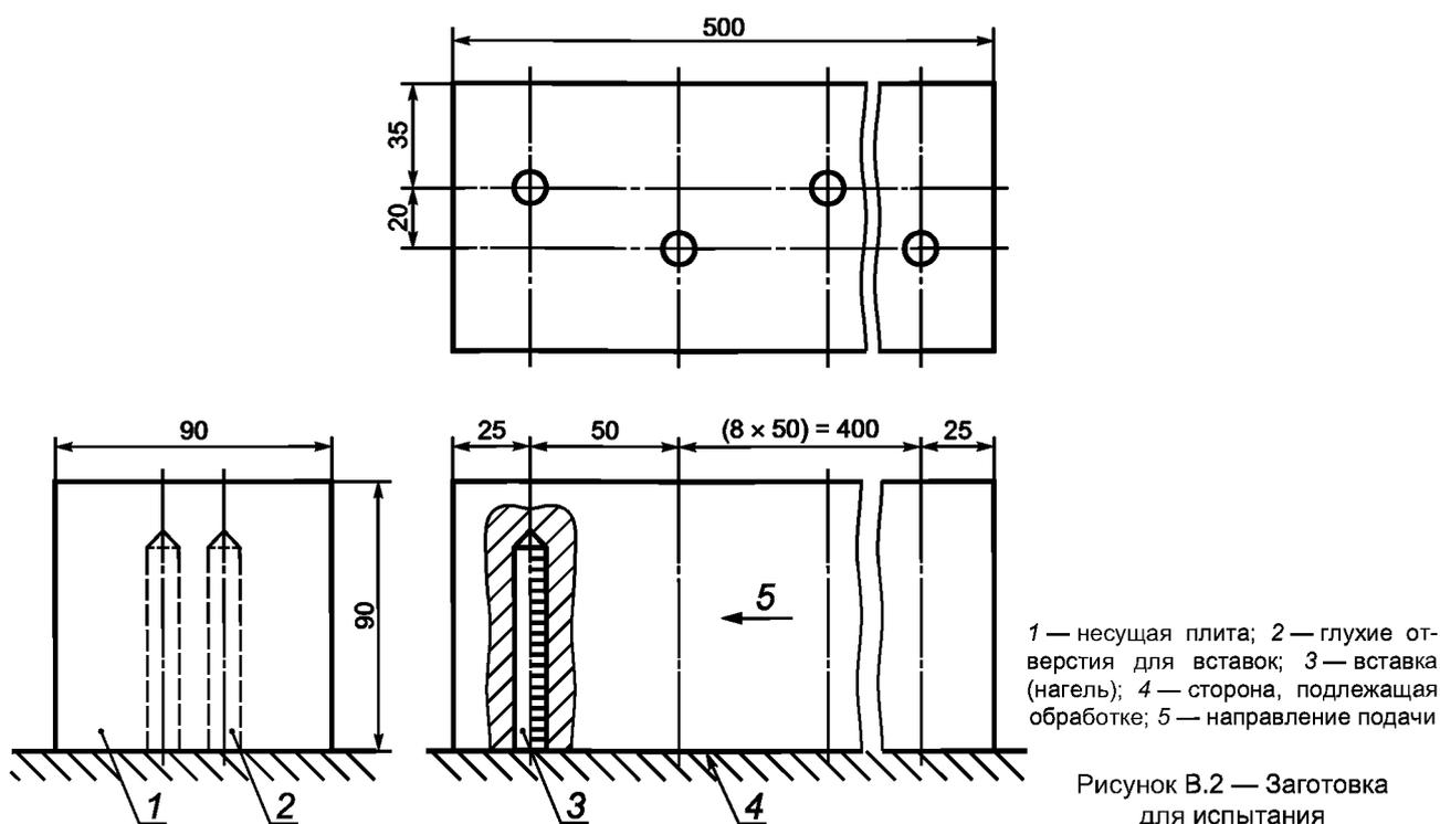
Рисунок В.2 — Заготовка для испытания
