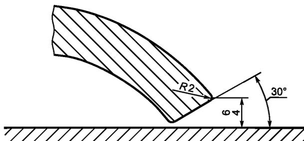
Рисунок 9 — Вариант 2: Конструкция кромки ограждения со стороны загрузки
