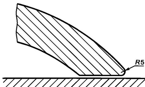
Рисунок 8 — Вариант 1: Конструкция кромки ограждения со стороны загрузки
