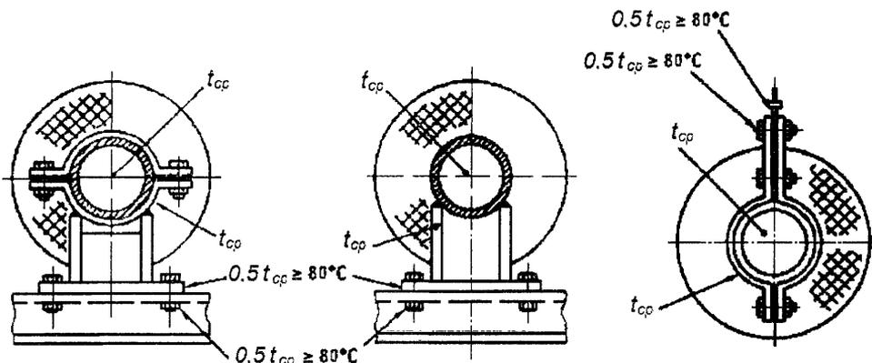
Рисунок 7.1 – Выбор температуры элементов опор внутри и снаружи изоляции
