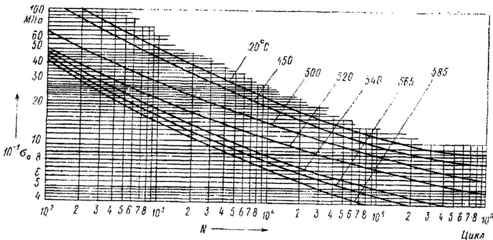
Рисунок 7.3 – Расчетные кривые малоциклового усталости низколегированных сталей марок 12МХ, 12ХМ, 12Х1МФ, 15Х1М1Ф
