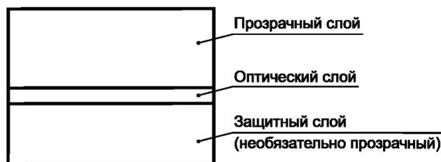
Рисунок 1 — Поперечное сечение карты в оптической зоне
