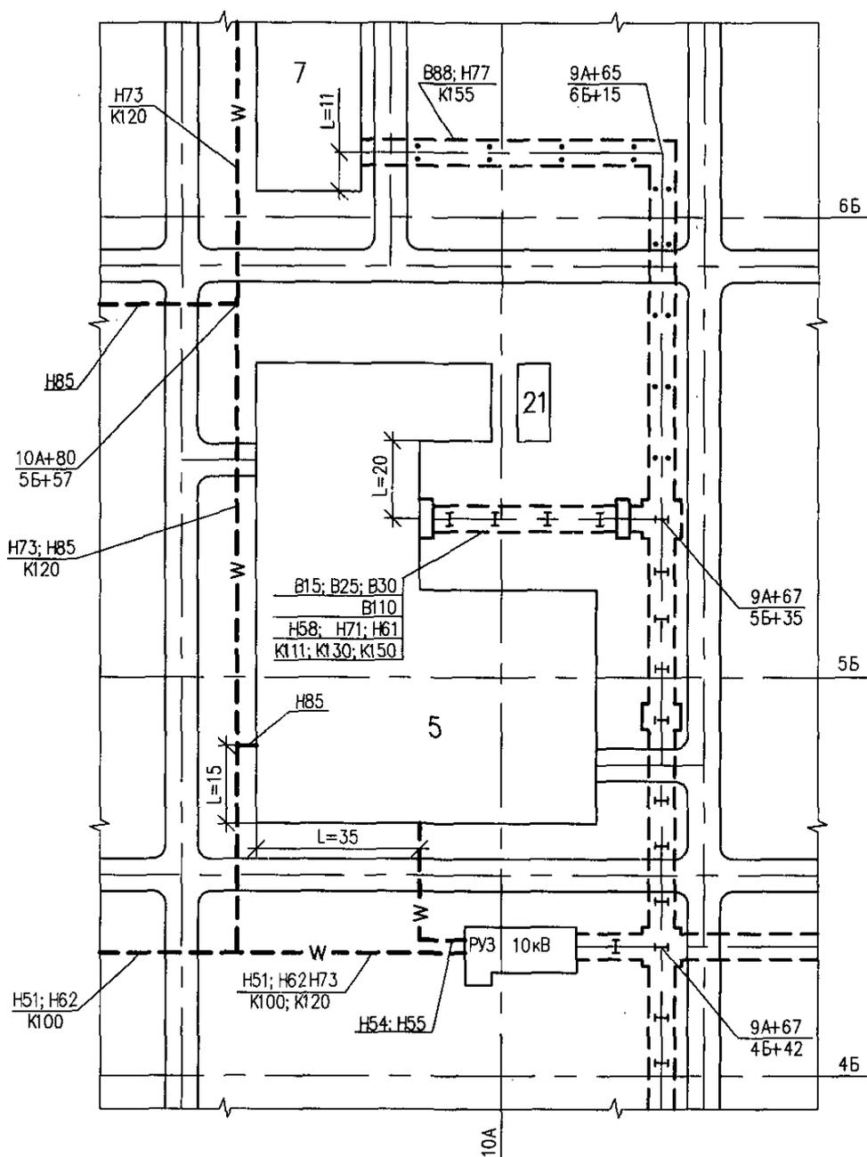
Рис. 28. Пример выполнения плана расположения кабельных трасс
