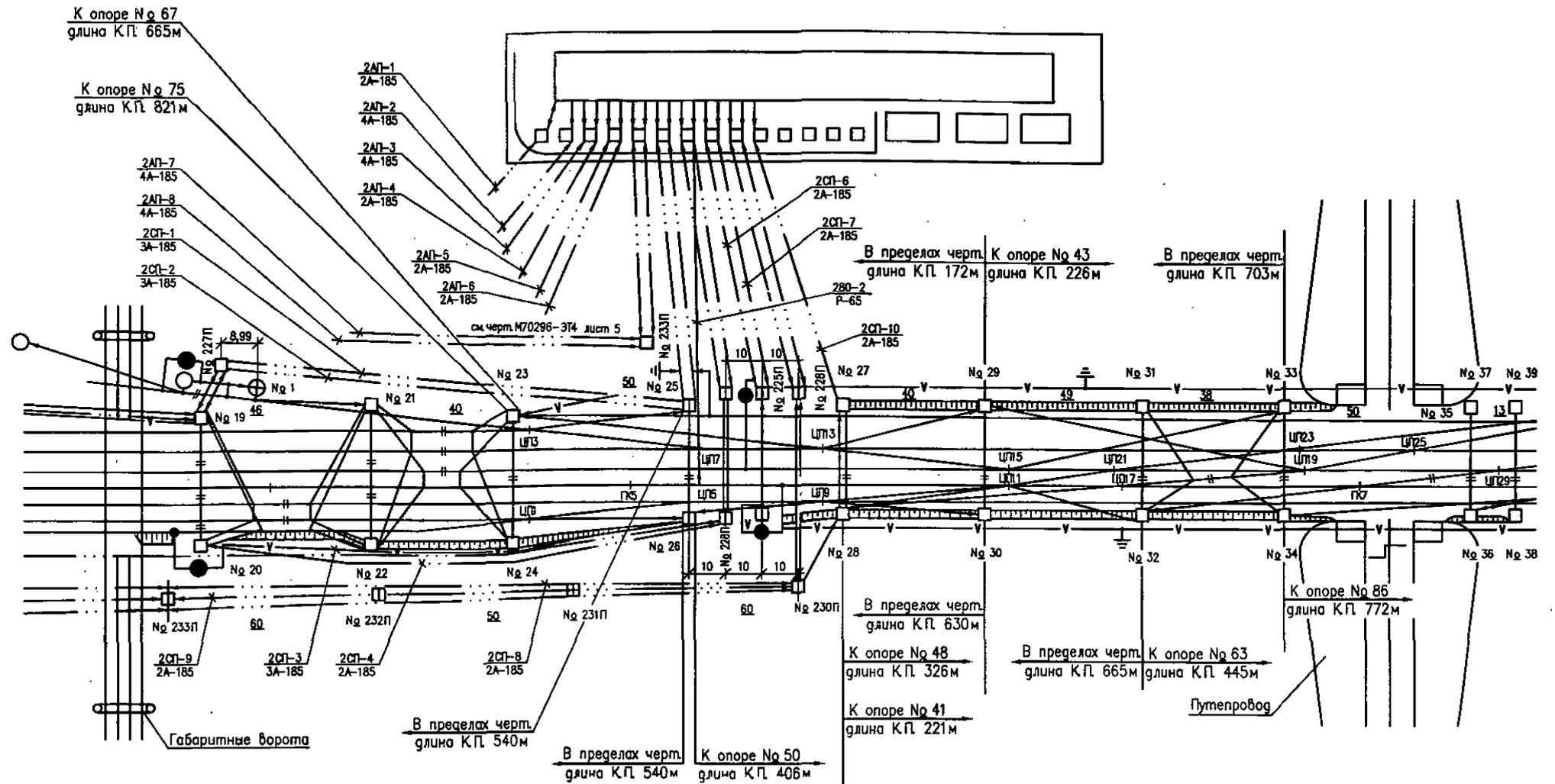
Рис. 30. Пример выполнения плана контактной сети, питающих и отсасывающих линий электрифицированного промышленного железнодорожного транспорта
