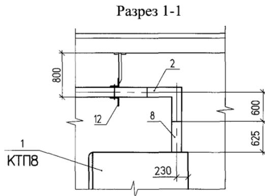
Рис. 35. Пример выполнения плана прокладки магистрального шинпровода (фрагмент)
