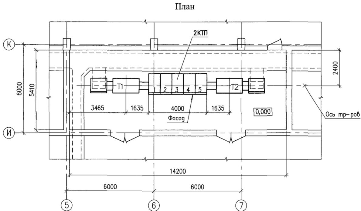
Рис. 36. Пример выполнения плана расположения 2КТП
