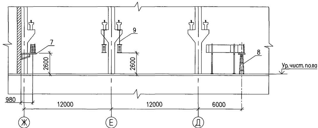
Рис. 38. Пример выполнения прокладки распределительных шинопроводов (разрез)
