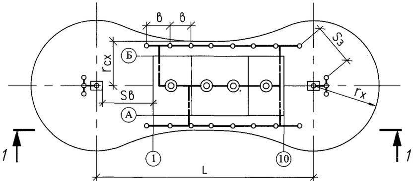
Рис. 29. Пример выполнения схемы размещения молниезащитного устройства и устройства наружного заземления
