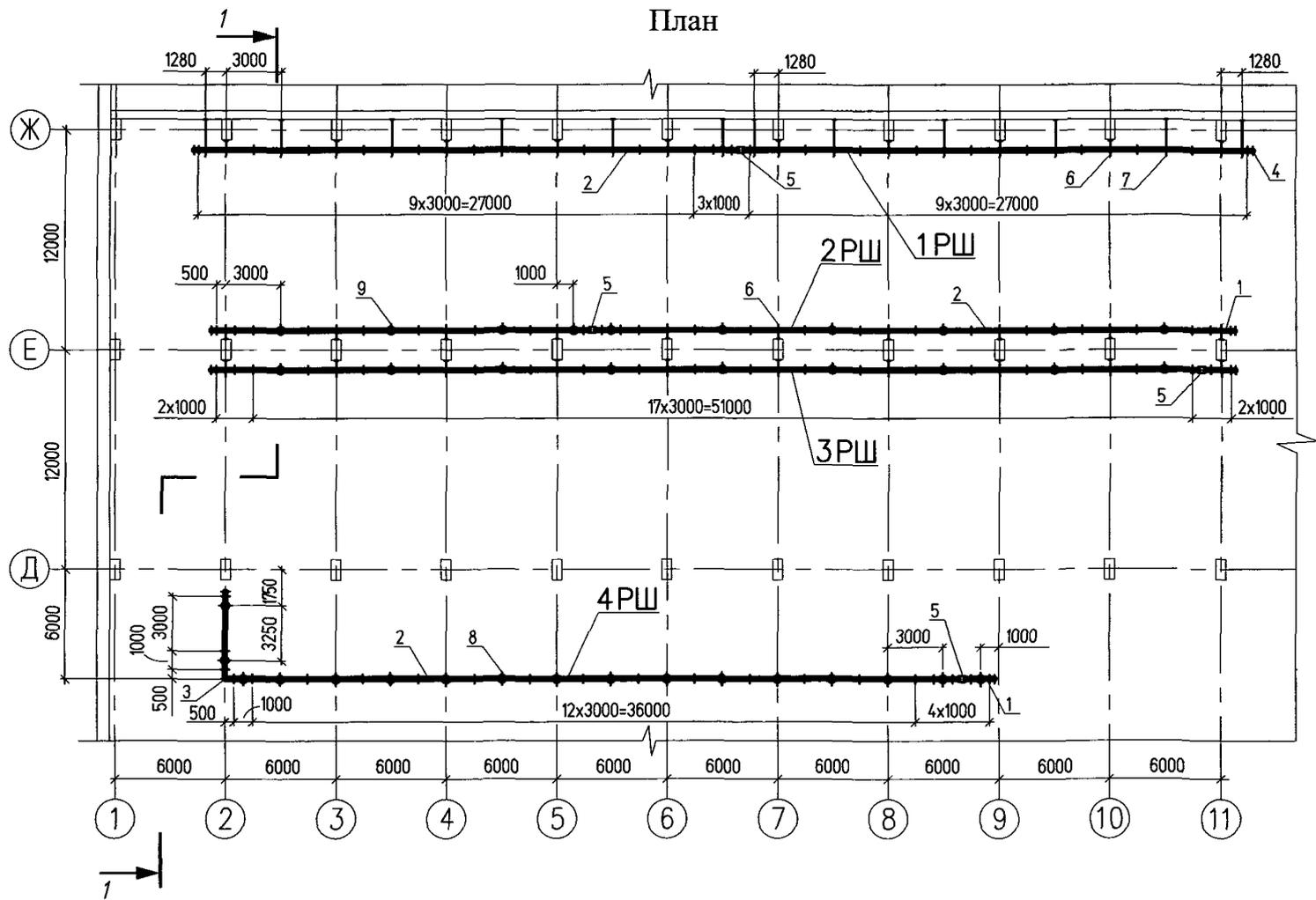
Рис. 37. Пример выполнения прокладки распределительных шинопроводов (план)
