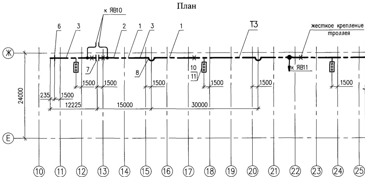
Рис. 34. Пример выполнения плана прокладки троллейных линий (фрагмент)
