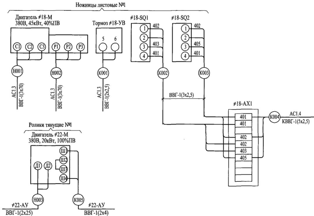
Рис. 32. Пример выполнения схемы подключения
