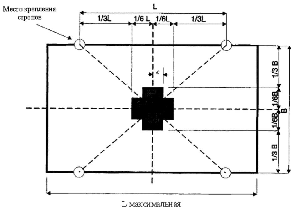
Рис. 3.3.4 Допускаемое положение ЦТ
