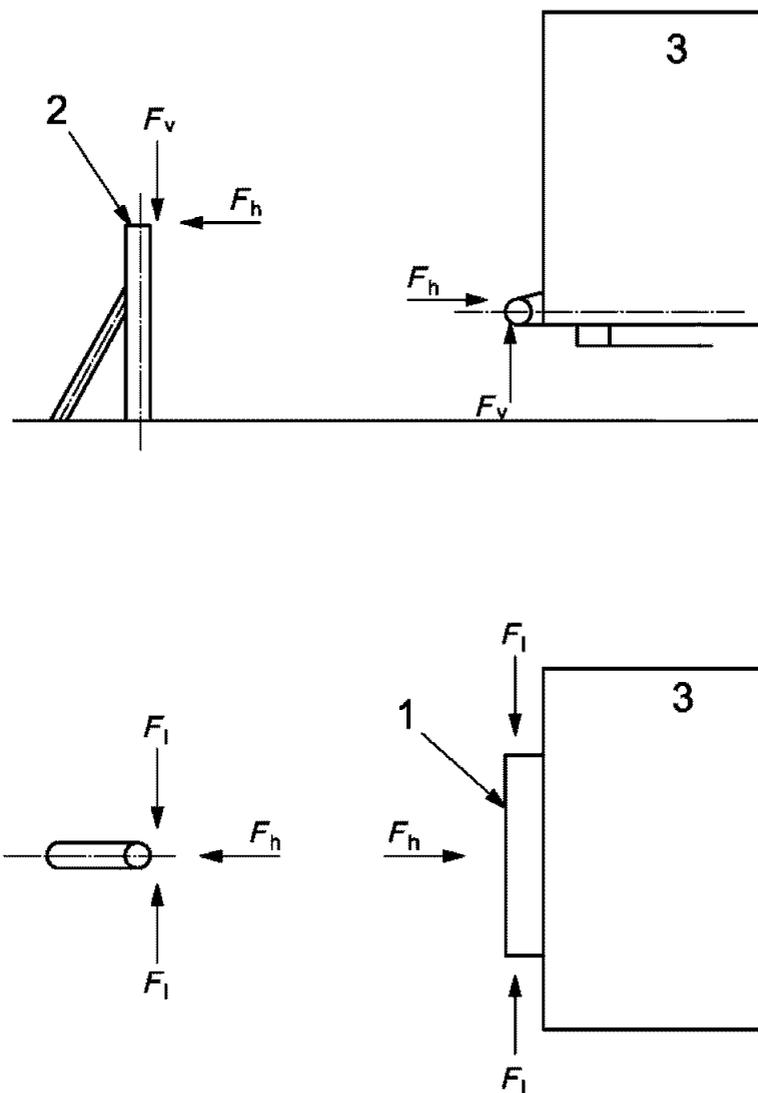
Рис. 1 Схема расположения "направляющие — привальный брусья (бамперы)":
