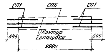
Схематический план расположения арматурных выпусков
