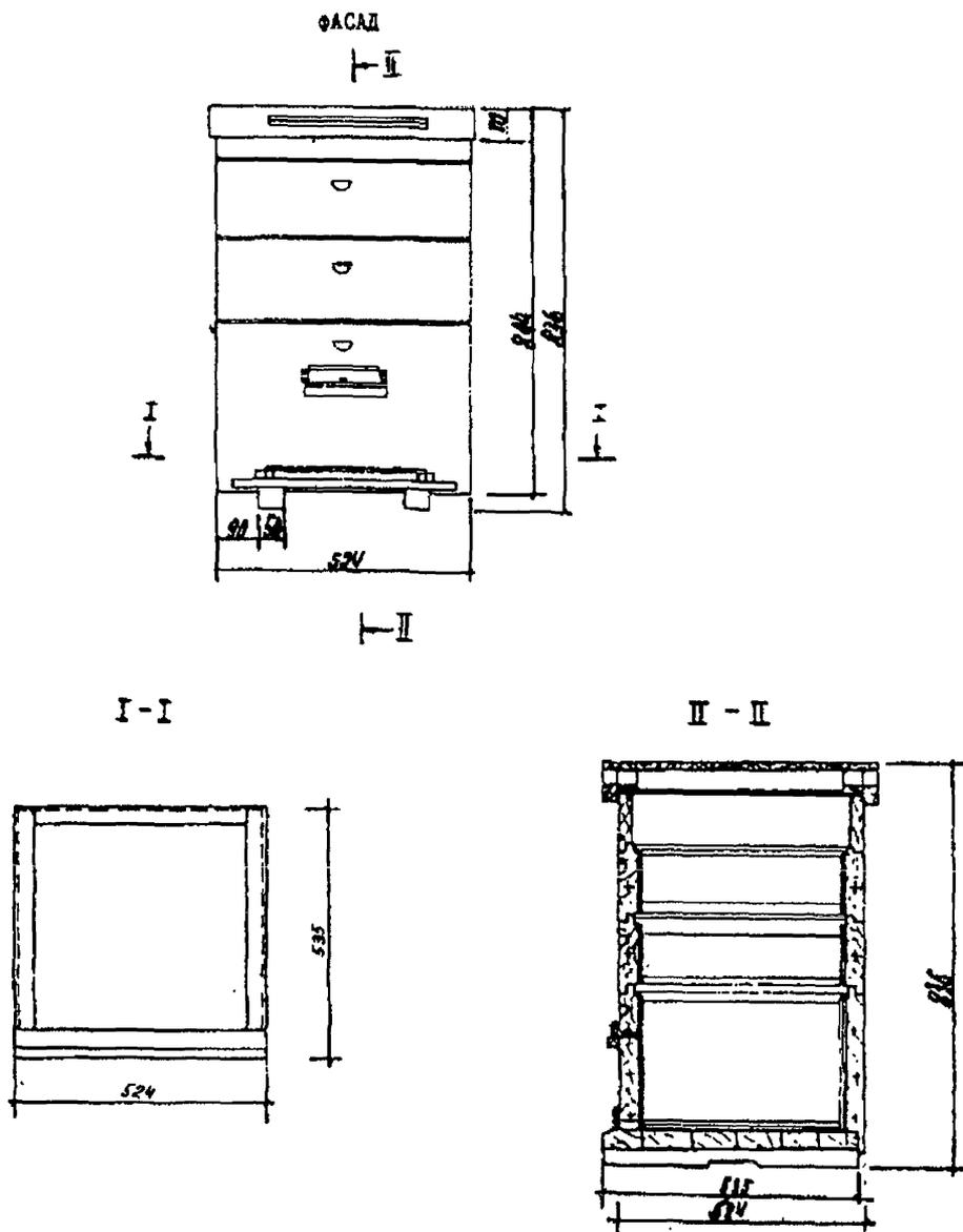
Рис. Е.5. Улей однокорпусный с двумя магазинами
