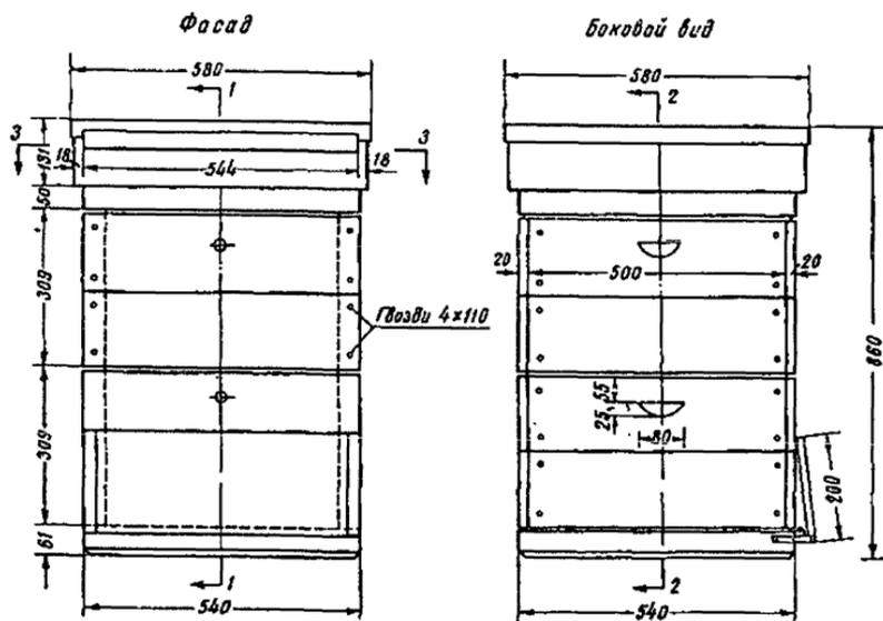
Рис. Е.1. Конструкция улья на 24 рамки:
