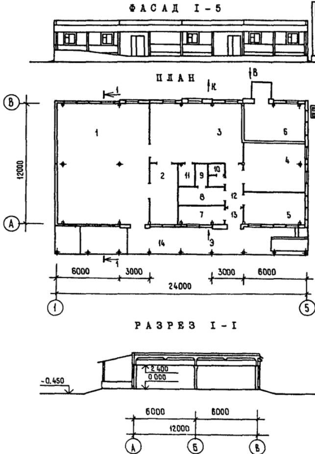
Рис. Г.1. Производственный корпус для пчеловодческой фермы на 600 пчелиных семей (ТП 808-5-40.86):
