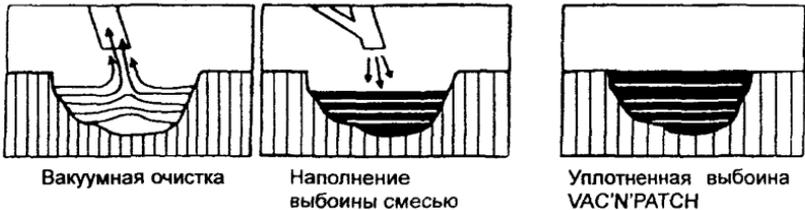
Рис. 7.7. Схема заделки выбоин по вакуумно-струйно-инъекционной технологии
