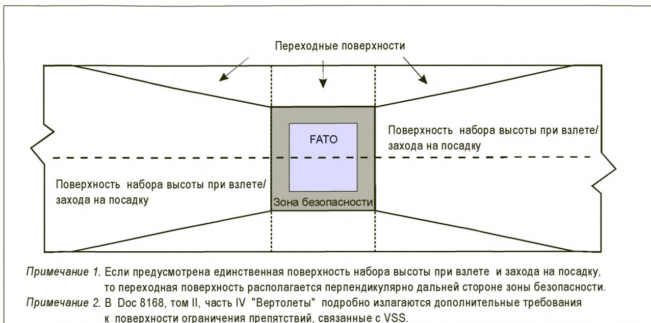
Рис. А2-5. Переходные поверхности для зоны FATO, оборудованной для точного и/или неточного захода на посадку
