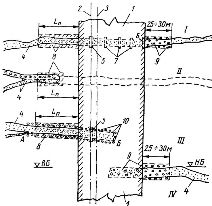
Рис. 5. Расположение открытых тектонических трещин в плане с показанием противofильтративных устройств
