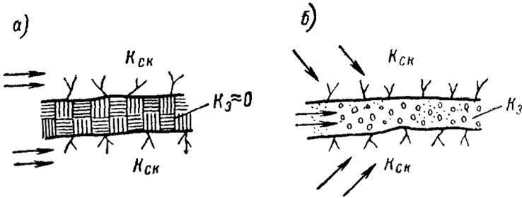
Рис. 3. Виды фильтрации в зависимости от значения коэффициентов фильтрации скалы основания  $k_{ск}$  и материала заполнителя трещин  $k_3$
