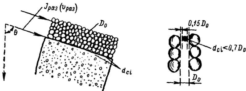
Рис. 4. Контактный размыв (схема)
