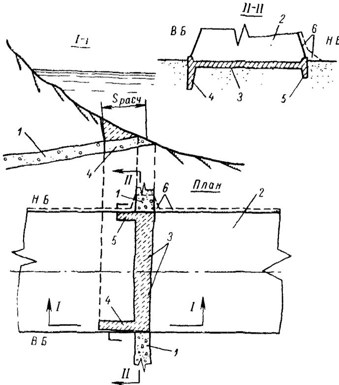
Рис. 9. Устройство бетонных подплотинных зубьев в наклонных тектонических трещинах
