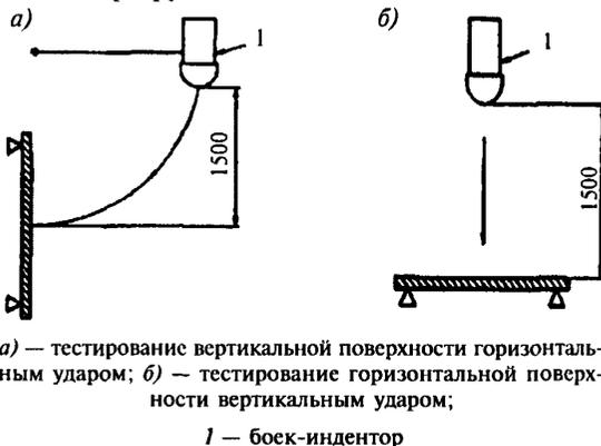
**Рисунок Д.7 — Схема установки поверхностных элементов для тестирования ударом**
