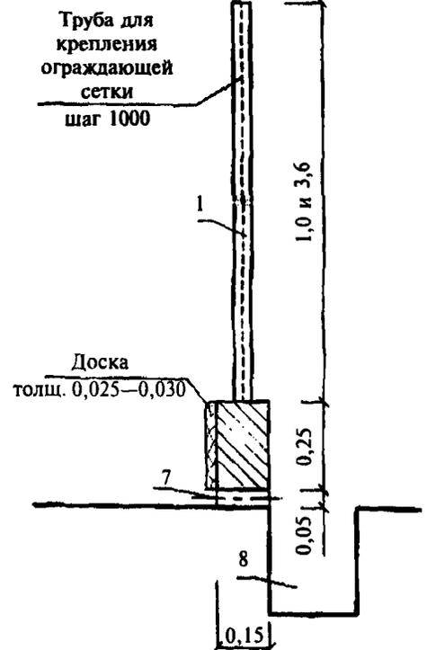
1 — ограждение (металлическая сетка); 2 — разметка поля для игры (цвет красный); 3 — ворота (размеры в свету — ширина 1550, высота 1050, глубина 920 мм); 4 — штрафная площадь; 5 — зоны противоборствующих команд; 6 — отметка штрафного удара; 7 — отверстие для выпуска дождевой воды (через 2300); 8 — водосборный лоток
