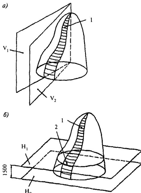
1 — секция для лазания; 2 — ширина маршрута К;  $V_1, V_2$  — вертикальные плоскости;  $H_1$  — горизонтальная плоскость;  $H_0$  — горизонтальная плоскость на уровне земли
