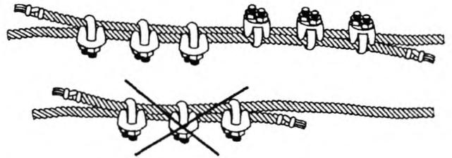
Рисунок В.4 — Размещение захватов проволочного каната
