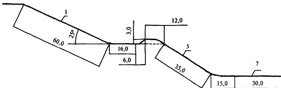
1 — разгон; 2 — переход от зоны разгона; 3 — стол отталивания; 4 — перегиб; 5 — зона приземления; 6 — переход от зоны приземления; 7 — выезд
