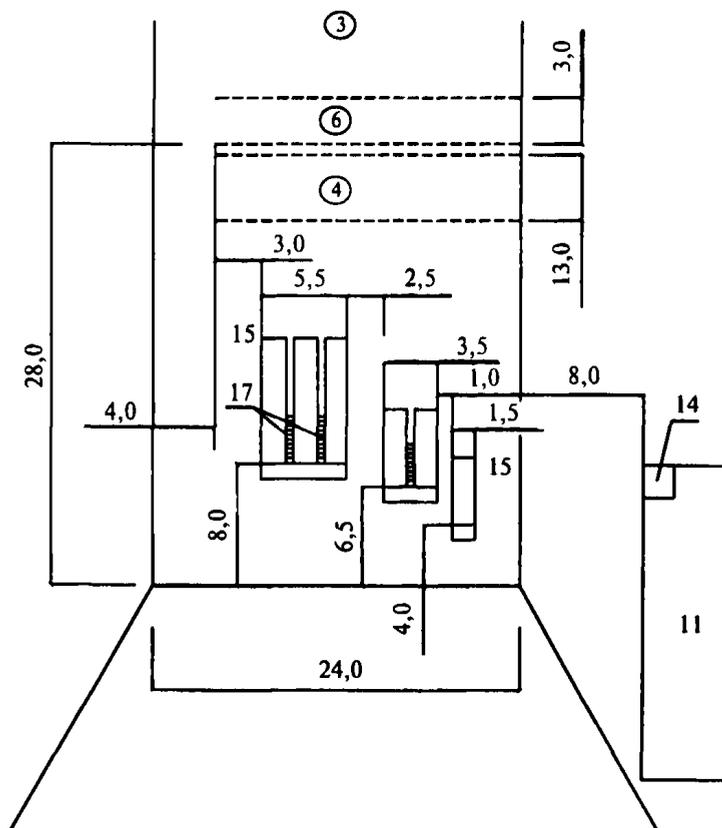
1 — зона старта; 2 — ограждение; 3 — разгон; 4 — переход; 5 — вешки разгона; 6 — контроль скорости; 7 — перегиб; 8 — зона приземления; 9 — зона финиша; 10 — зона для спортсменов и тренеров; 11 — трибуна судей; 12 — дисплей скорости и обработанного отсчета; 13 — ветроуказатель; 14 — место управляющего скоростным спуском; 15 — скоростная полоска; 16 — подъезд для ратрака; 17 — ступени
