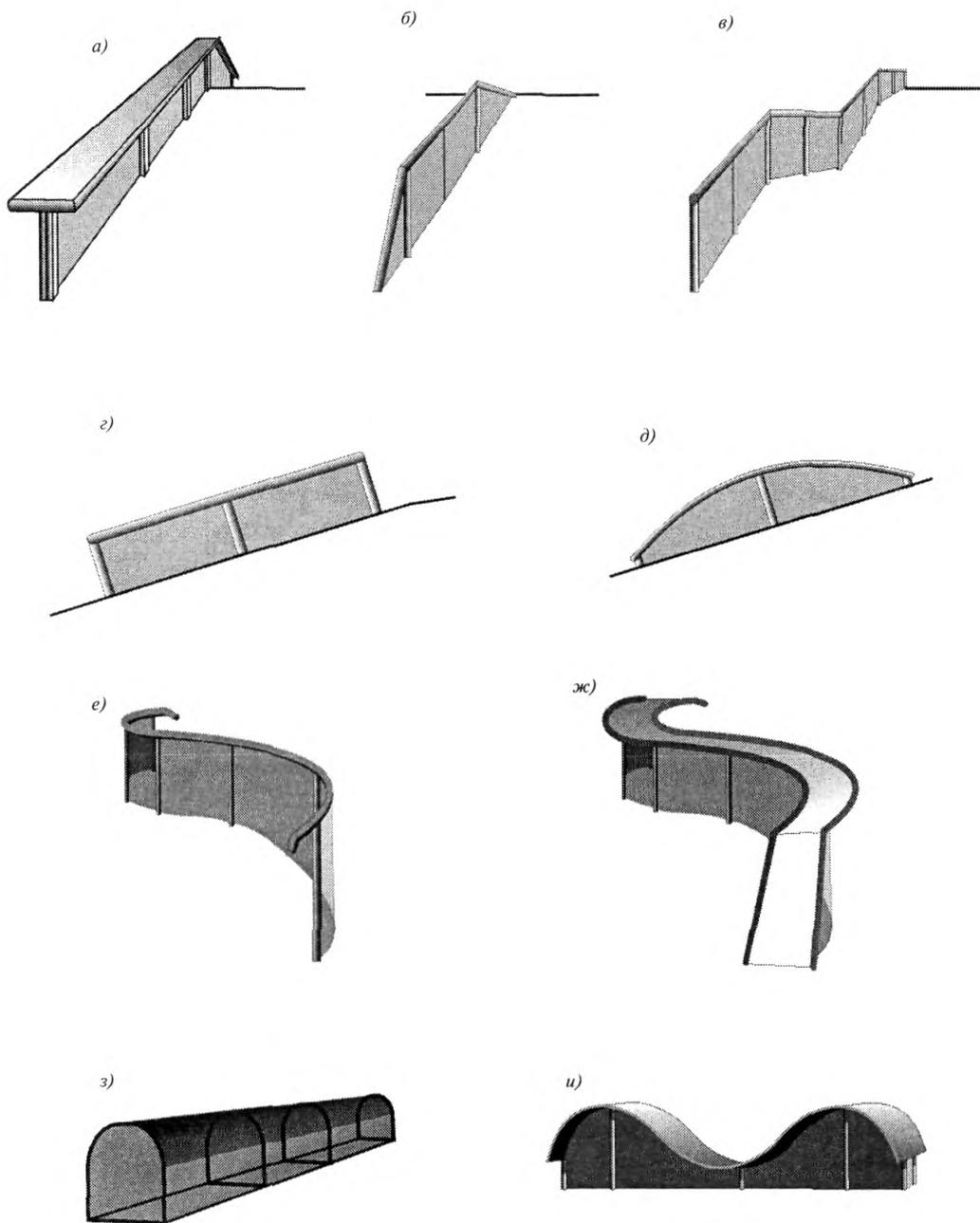
*a* — Фан-бокс (funbox); *б* — трапеция А-рэйл (A-rail); *в* — кинк-рэйл (kink-rail); *г* — рэйл (rail); *д* — радуга; *е* — S-рэйл (вариант — С-рэйл); *ж* — S-фан-бокс (вариант — С-фан-бокс); *з* — Мэйл-бокс (mailbox); *и* — верблюду
