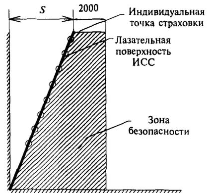
Схема 4.3 — Расчет зоны безопасности при использовании нижней страховки
