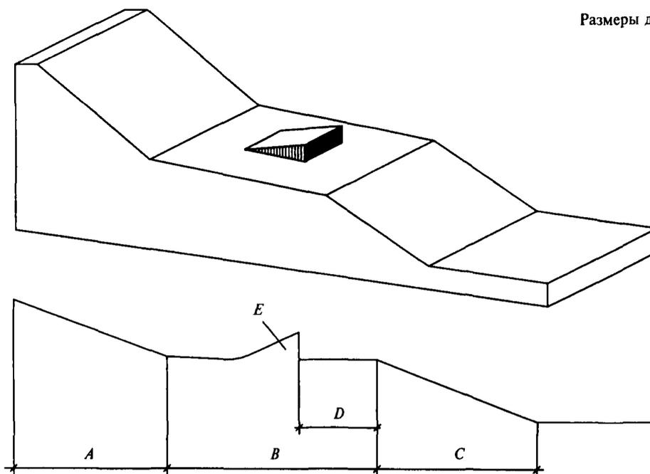
$A$  — разгон;  $B$  — стол;  $C$  — приземление;  $D$  — транзит;  $E$  — кикер (трамплин)
