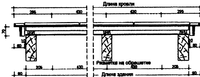
Рис. 21. Продольный разрез кровли с применением на фронтоне боковой черепицы (левой и правой).
