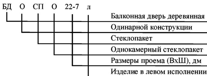
Рисунок 1 – Структура условного обозначения оконного блока ОД ОСПО15-9ФШл и дверного балконного блока БД ОСПО22-7
