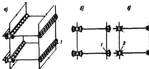
Рис. 1. Схемы при расчете на изгиб из плоскости:
