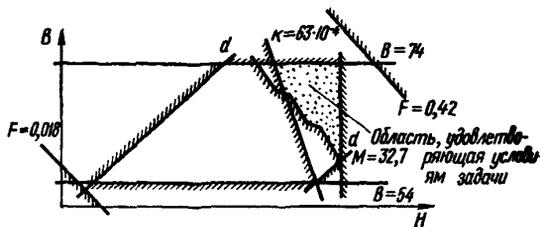
Рис. 18. Номограмма для определения оптимального сечения ребер панели перекрытия.
