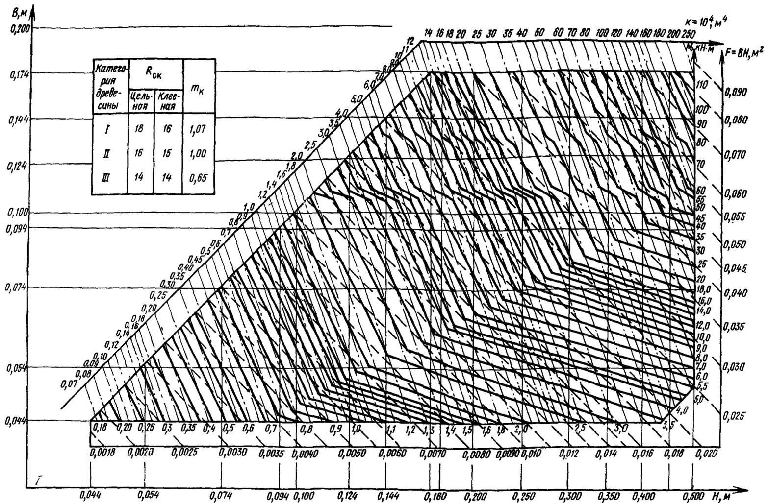
Рис. 21. Номограмма для подбора оптимальных сечений изгибаемых элементов при расстоянии между точками закрепления  $l_p = 3,6$  м:
