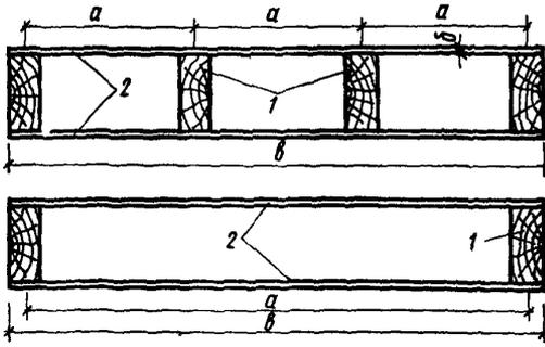
Рис. 10. Поперечные сечения клефанерных панелей коробчатого сечения:
