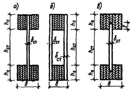
Рис. 11. Поперечные сечения клееных балок с плоской фанерной стенкой:
