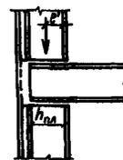
Рис. 5. Платформенный стык панелей наружных стен и перекрытий (междуэтажных, цокольных, чердачных)
