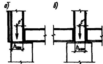
Рис. 4. Контактный стык:
