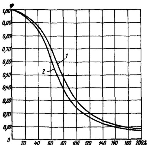
Рис. 8. График для определения коэффициента продольного изгиба: 1 - фанеры с  $A=3000, a=0,8$ ; 2 - древесины с  $A=2500, a=1$
