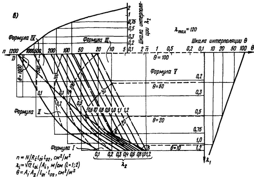
Рис. 22. Номограмма для подбора оптимальных сечений центрально-сжатых элементов:
