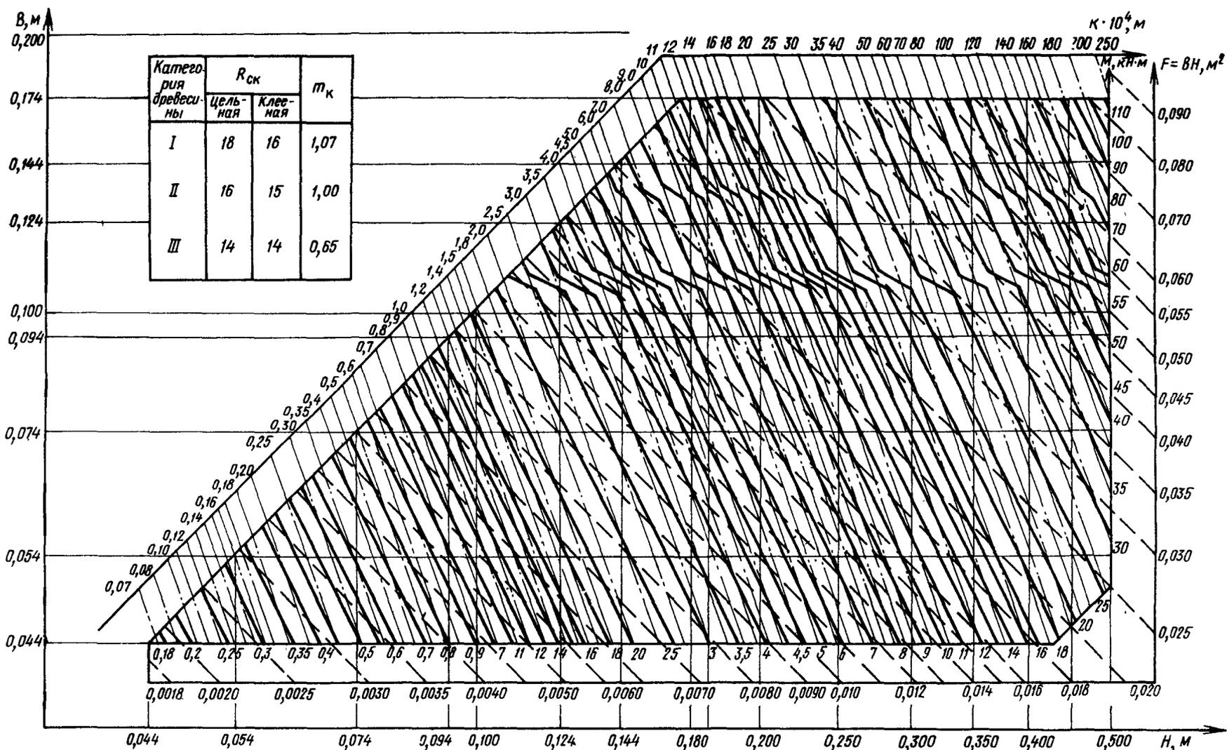
Рис. 19. Номограмма для подбора оптимальных сечений изгибаемых элементов при расстоянии между точками закрепления  $l_p < 0,7$  м:
