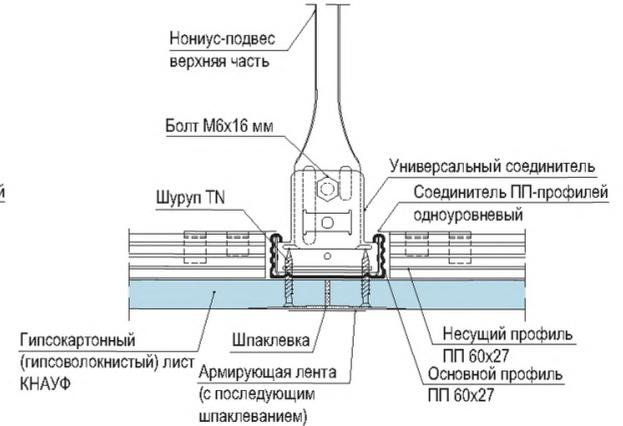
1. Для крепления ГВЛ к каркасу вместо шурупа TN применяется шуруп MN.
