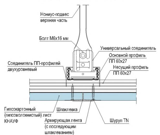
1. Для крепления ГВЛ к каркасу вместо шурупа TN применяется шуруп MN.
