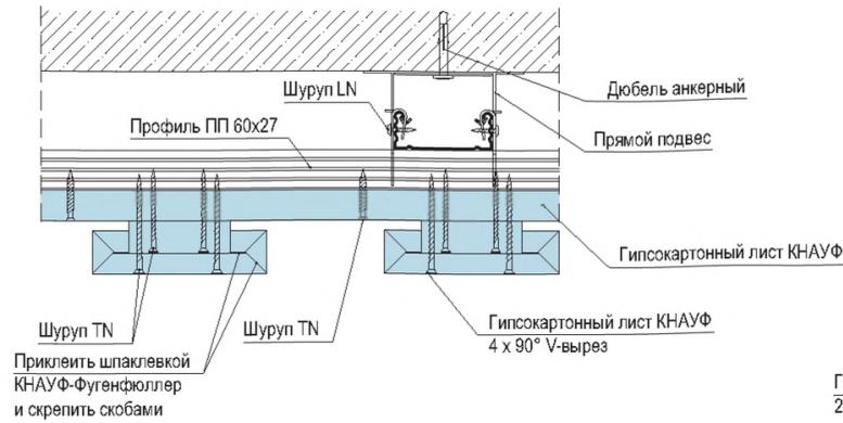
Пример применения - потолочный блок - ступенчатое расположение
