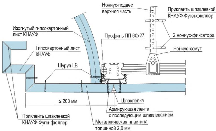
Пример применения – создание выступа при помощи профиля UA 50x40
