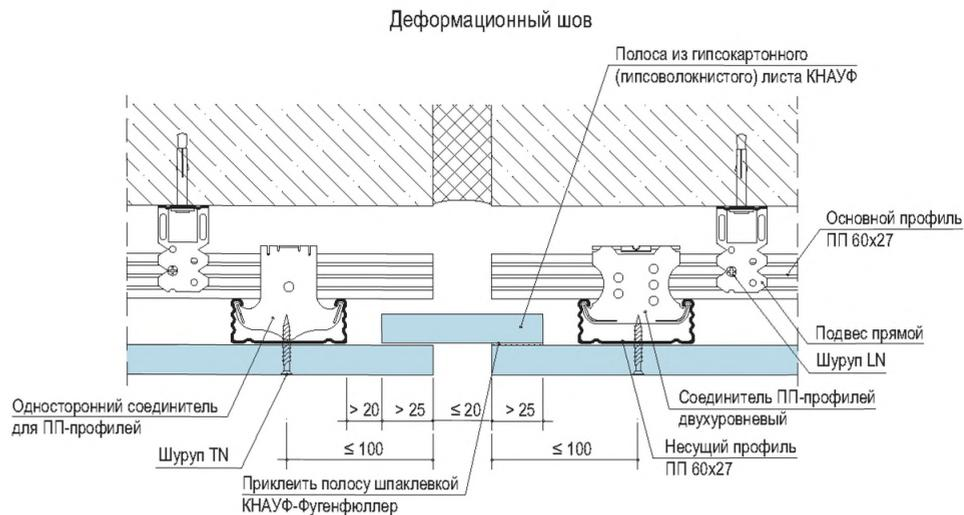
Деформационный шов устраивать через каждые 15 м по длине подвесного потолка и в местах устройства деформационного шва несущих конструкций.
