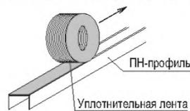
ПН-профиль 28x27 должен быть закреплен не менее чем тремя дюбелями. При нагрузке подвесного потолка более 25 кг/м<sup>2</sup>, боковые стороны одноуровневого соединителя дополнительно закрепляются к несущему профилю шурупами LN. Межосевое расстояние при устройстве каркаса подвесного потолка П113 см. документ 1.045.9-2.08.1-3.
