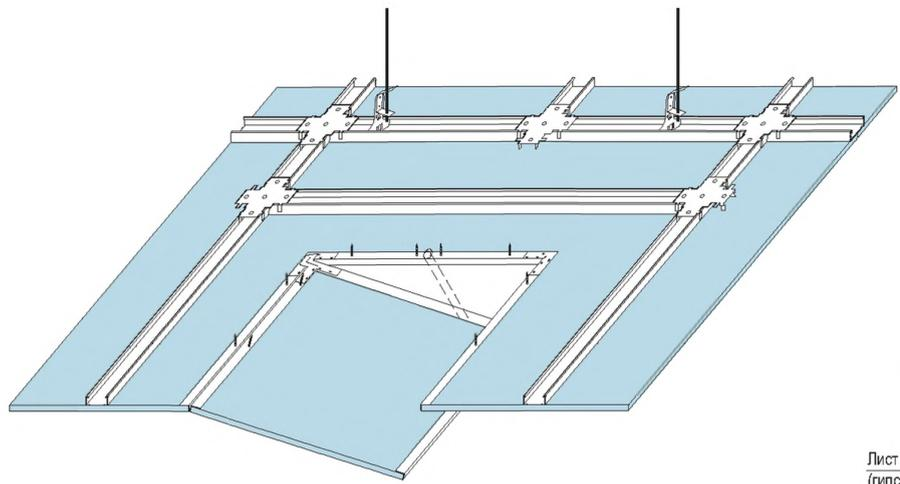
Вариант устройства ревизионного люка в конструкции подвесного потолка П113 (П213) (вид потолка сверху)
