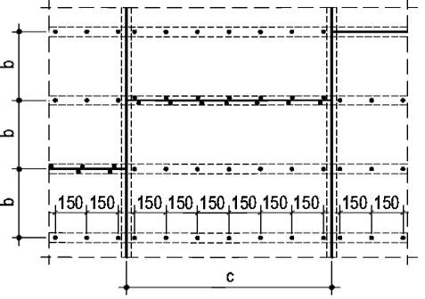
Крепежные шурупы должны входить в гипсокартонный или гипсоволокнистый лист под прямым углом и проникать в металлический профиль каркаса на глубину не менее 10 мм, а в деревянный брус – не менее 20 мм. Головки шурупов должны быть утоплены в гипсокартонный или гипсоволокнистый лист на глубину около 1 мм с целью их последующей шпаклевки.
