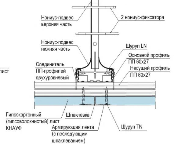
1. Для крепления ГВЛ к каркасу вместо шурупа TN применяется шуруп MN.
