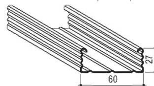
**Потолочный профиль (ПП 60x27)** имеет С-образную форму и служит для формирования каркаса подвесных потолков с облицовкой гипсокартонными (гипсоволокнистыми) листами. Монтируется в паре с соответствующим по размеру потолочным направляющим профилем (ПН 28x27).
