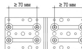
Крепление металлического уголка к стене из кирпича, бетона
