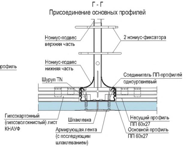
1. Для крепления ГВЛ к каркасу вместо шурупа TN применяется шуруп MN.
