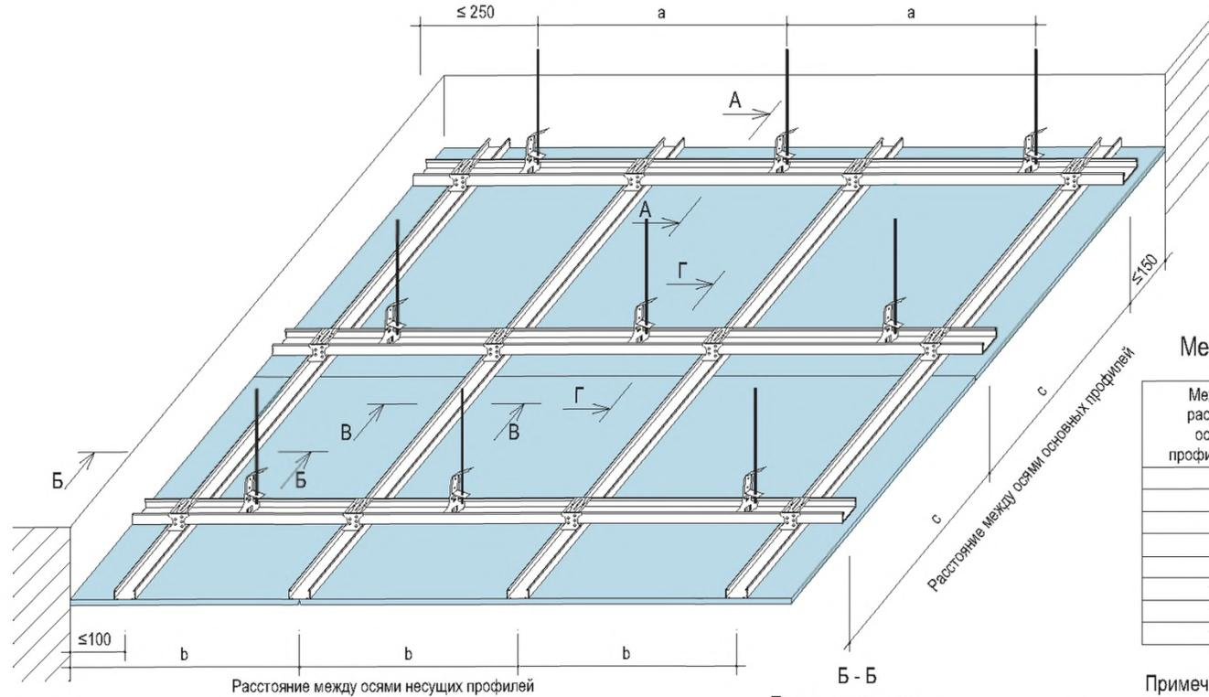
Межосевые расстояния при устройстве каркаса
