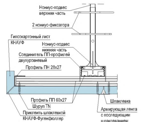
Размеры выступа определены из расчета толщины ГКЛ - 12,5 мм
