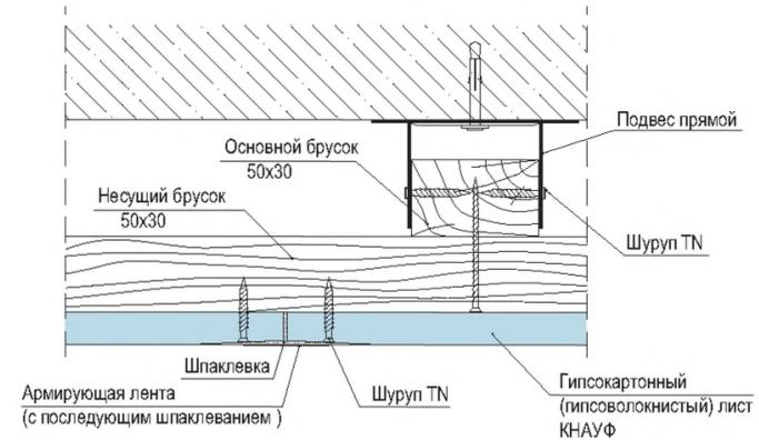
1. Для крепления ГВЛ к каркасу вместо шурупа TN применяется шуруп MN.
