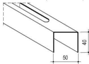
**Усиленный потолочный профиль (УА 50x40x2,0)** имеет П-образную форму и служит для формирования усиленного каркаса подвесных потолков с облицовкой гипсокартонными (гипсоволокнистыми) листами. Монтируется в паре с потолочным направляющим профилем (ПП 60x27). Фактический размер ширины УА-профиля (50 мм) несколько меньше и составляет 48 мм.
