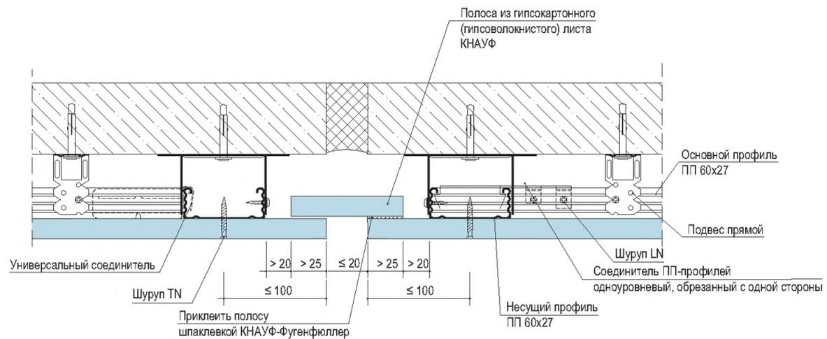
Деформационный шов устраивать через каждые 15 м по длине подвесного потолка и в местах устройства деформационного шва несущих конструкций
