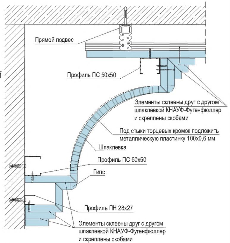
Пример применения – облицовка балки
