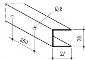
**Потолочный направляющий профиль (ПН 28x27)** имеет С-образную форму и служит в качестве направляющего для потолочного профиля. Монтируется в паре с соответствующим по размеру потолочным профилем (ПП 60x27).
