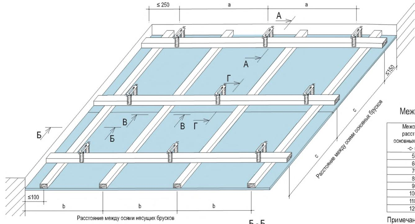
Межосевые расстояния при устройстве каркаса
