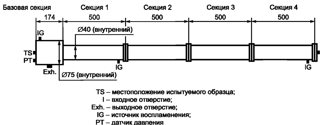
Рисунок 21 — Установка для испытаний дыхательных и дренажных устройств
