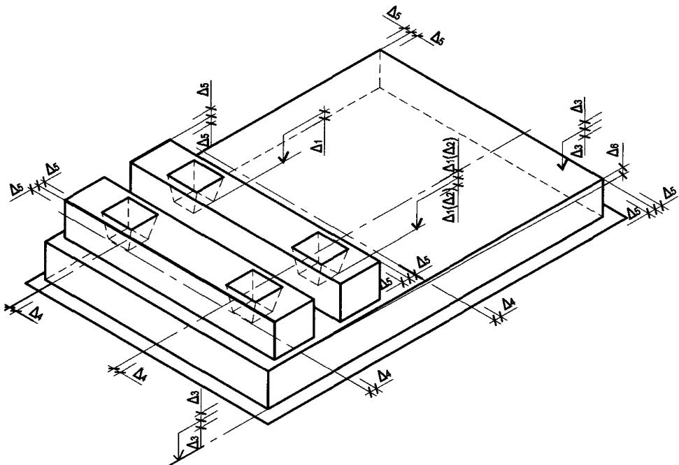
Рисунок 7. Схема монтажа фундаментных блоков устоев козлового типа с указанием предельных отклонений
