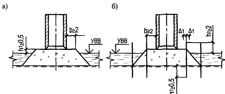
Рисунок 2. Устройство островков для погружения опускных колодцев
