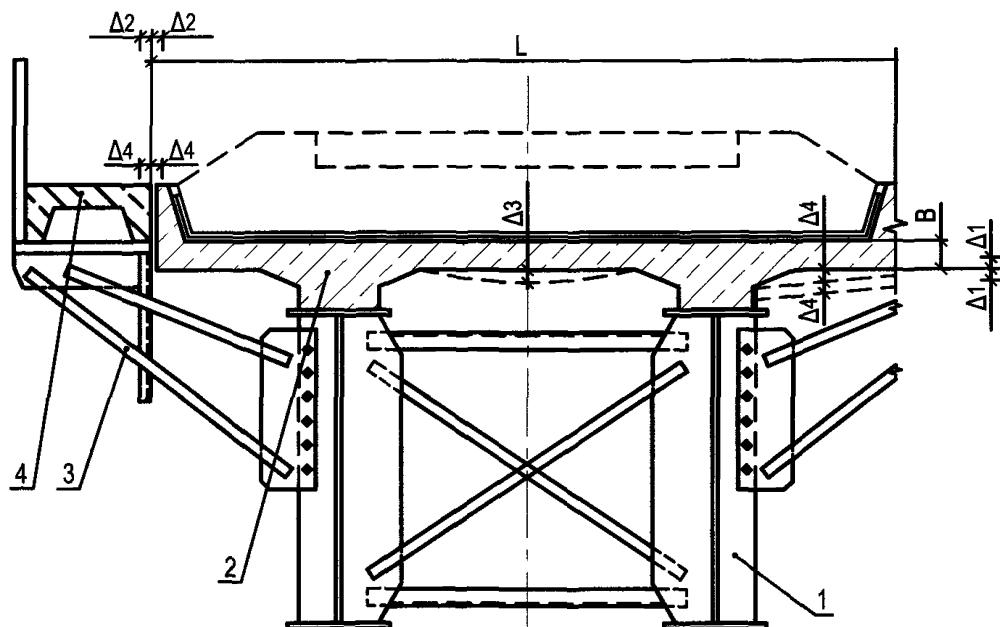
Рисунок 13. Схема устройства сборной железобетонной проезжей части сталежелезобетонного железнодорожного пролетного строения с указанием предельных отклонений
