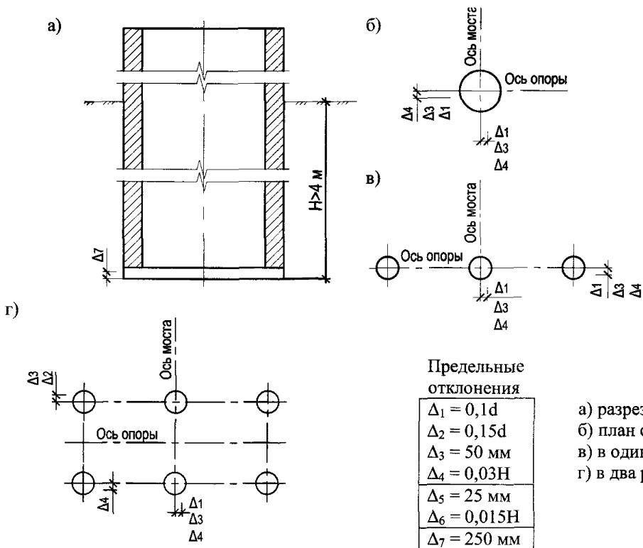
Рисунок 3. Схема оболочки большого диаметра с указанием предельных отклонений
