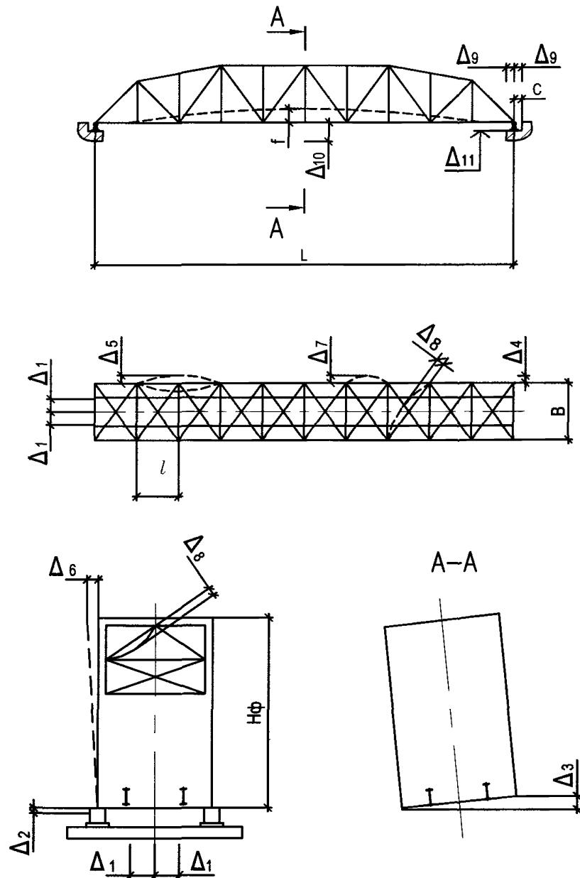
Рисунок 14. Схема пролетного строения с указанием предельных отклонений
