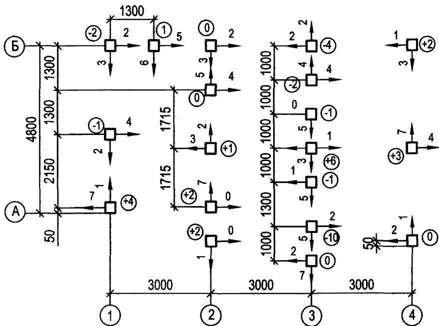
Стрелка показывает направление отклонения оголовка сваи от оси,
