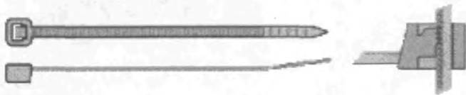
Рис. 8.3.2. Стяжки (хомуты) кабельные стандартные одноразовые
