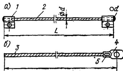
В местах сварных, болтовых и заклепочных соединений металлических строительных конструкций устанавливать гибкие перемычки не требуется.
