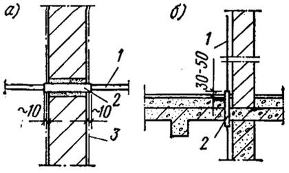
При крепении заземляющих проводников должны соблюдаться следующие расстояния:
