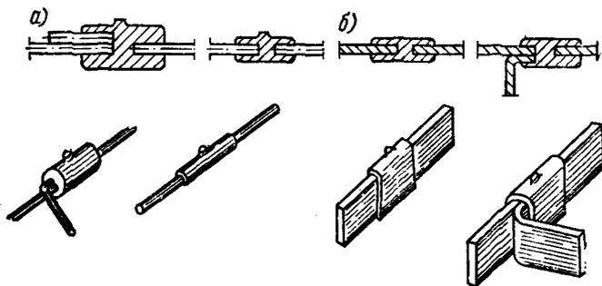
Рис. 11. Соединения заземляющих проводников, выполненные термитной сваркой
