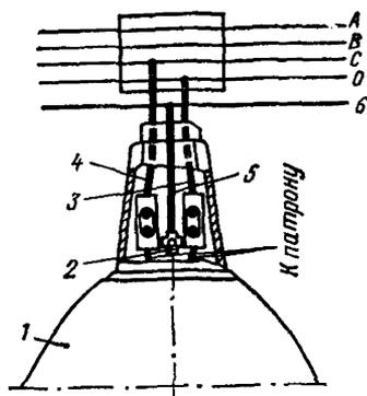
торой светильник установлен, то между этой конструкцией, кронштейном и корпусом светильника должно быть обеспечено надежное электрическое соединение.
