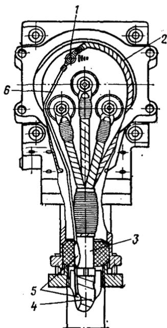
Рис. 30. Общий вид смонтированного вводного устройства электродвигателей ВАО 4—9 габаритов
