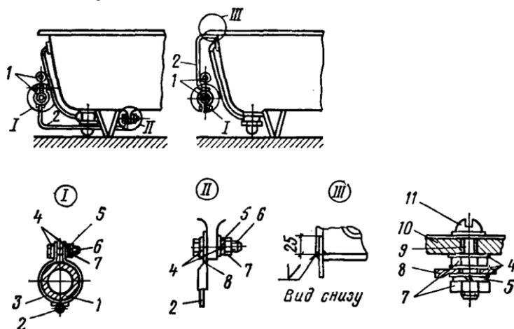
Рис. 29. Соединение металлического корпуса ванн с трубами водопровода
