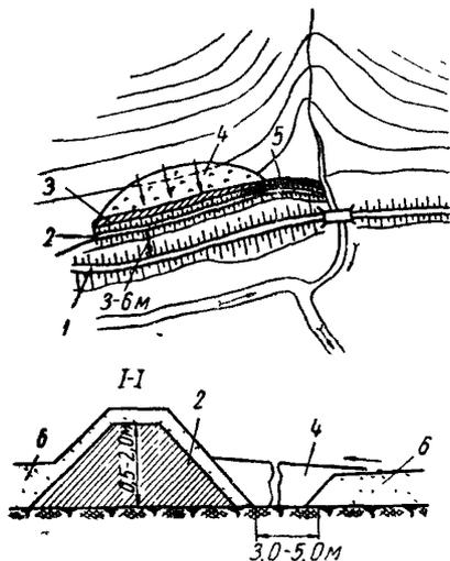
Рис. 7. Схема устройства задерживающих валов:
