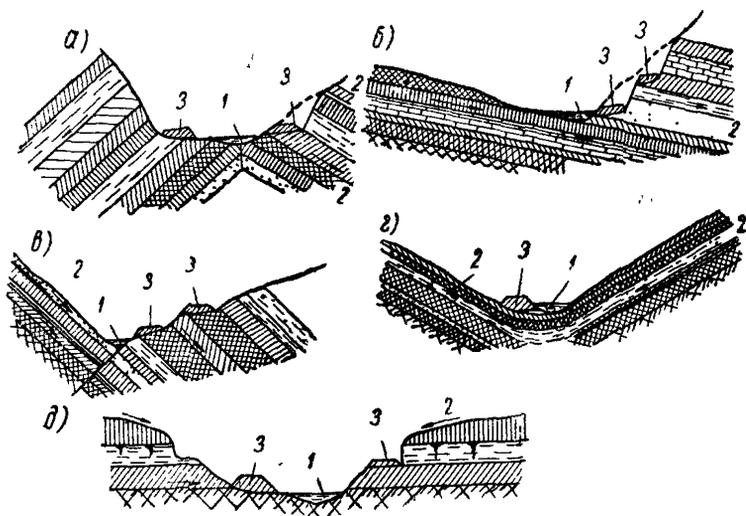
Рис. 1. Рекомендуемые варианты трассирования дороги (долинным ходом) в наледных районах в полунасыпи на разной высоте (по местным условиям) склона (а, б, в) и в насыпи прирусловой части поймы (г, д):
