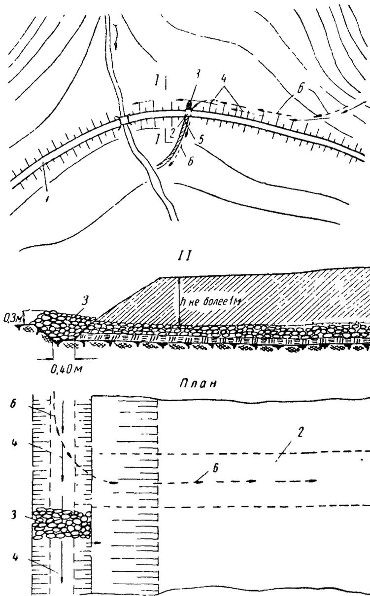
**Рис. 5. Схема устройства перепуска бортового стока через фильтрующую прорезь:**
