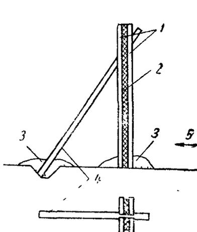
Рис. 8. Схема использования снегозадерживающих планочных щитов для задержания натечных наледей.
