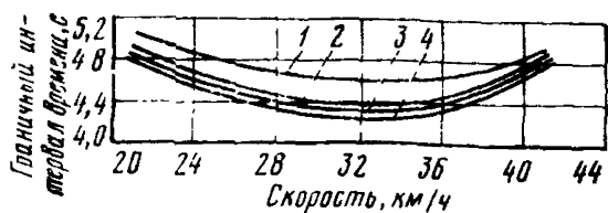
Рис 38. Зависимость величины критических интервалов на кольцевых пересечениях от скорости движения приоритетного потока и угла \alpha слияния потоков
