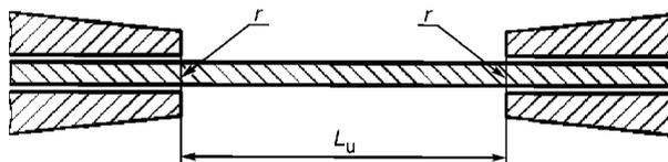
$L_u$  — эффективная длина, измеренная без нагрузки;  $r$  — ограничительные отметки для стандартного испытания
