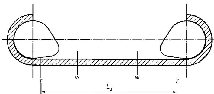
$L_u$  — эффективная длина, измеренная без нагрузки;  $r$  — ограничительные отметки для стандартного испытания;
