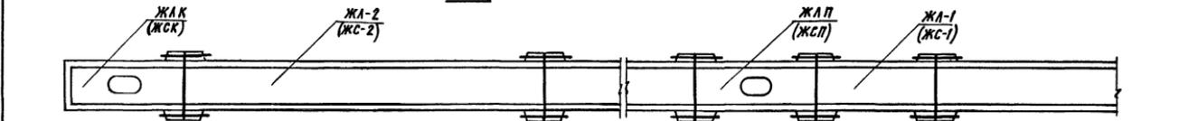
Схема стыковки желобов линейных со стыковыми
