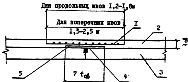
Рис. 2. Конструкция армирования однослойного асфальтобетона: 1 - стеклопластиковая сетка; 2 - слой усиления из асфальтобетона; 3 - существующее жесткое покрытие; 4 - побелка известковым молоком; 5 - пергамин
