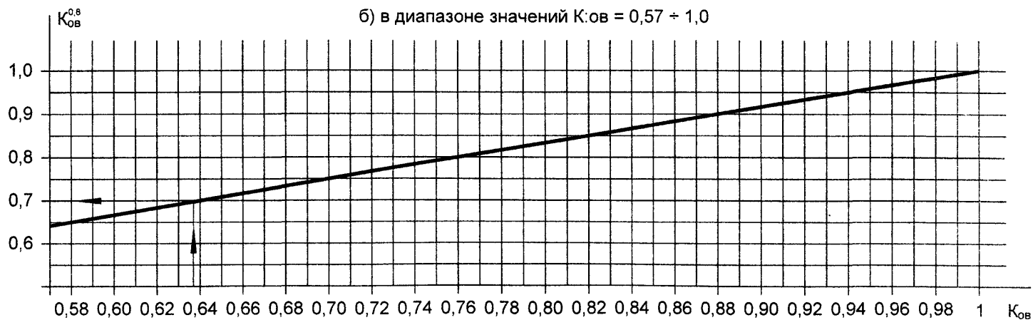
Рисунок А.4 - Коэффициент снижения расхода тепла на отопление и вентиляцию в степени 0,8 (для определения температуры прямой сетевой воды на выходе из котельной).
