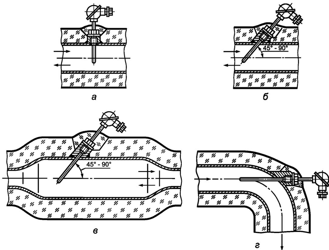
Рисунок 1 — Схема расположения чувствительного элемента преобразователя температуры: а — радиальное; б — наклонное; в — в расширителе; г — в изгибе колена
