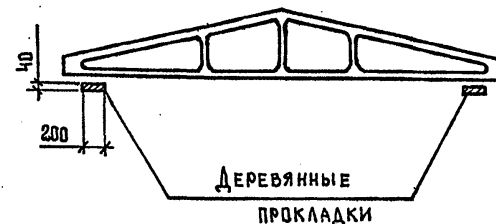
СХЕМА ОПИРАНИЯ ФЕРМ ПРИ ХРАНЕНИИ И ПЕРЕВОЗКЕ
