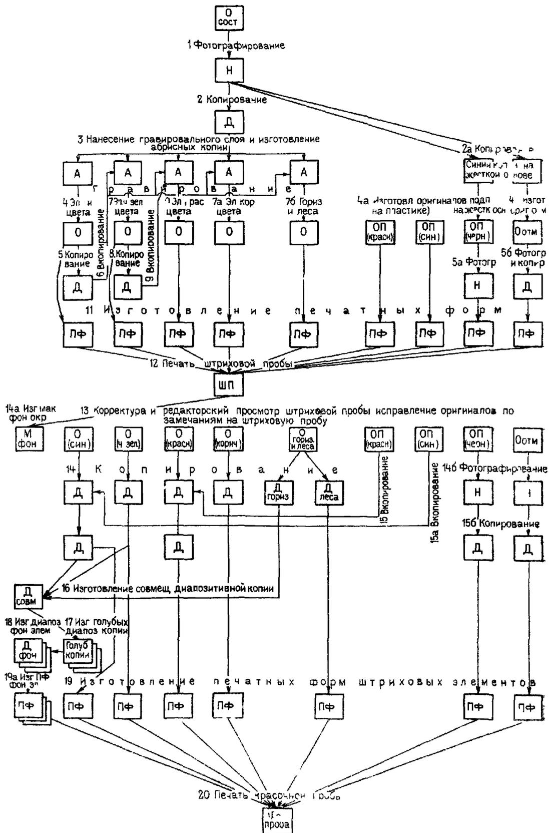
Условные обозначения О-оригинал, А-абрис, Н-негатив, Д-диапозитив, М-макет, ПФ-печатная форма, ШП-штриховая проба, ОП-оригинал подлиси Оотм-оригинал отмычки рельефа
