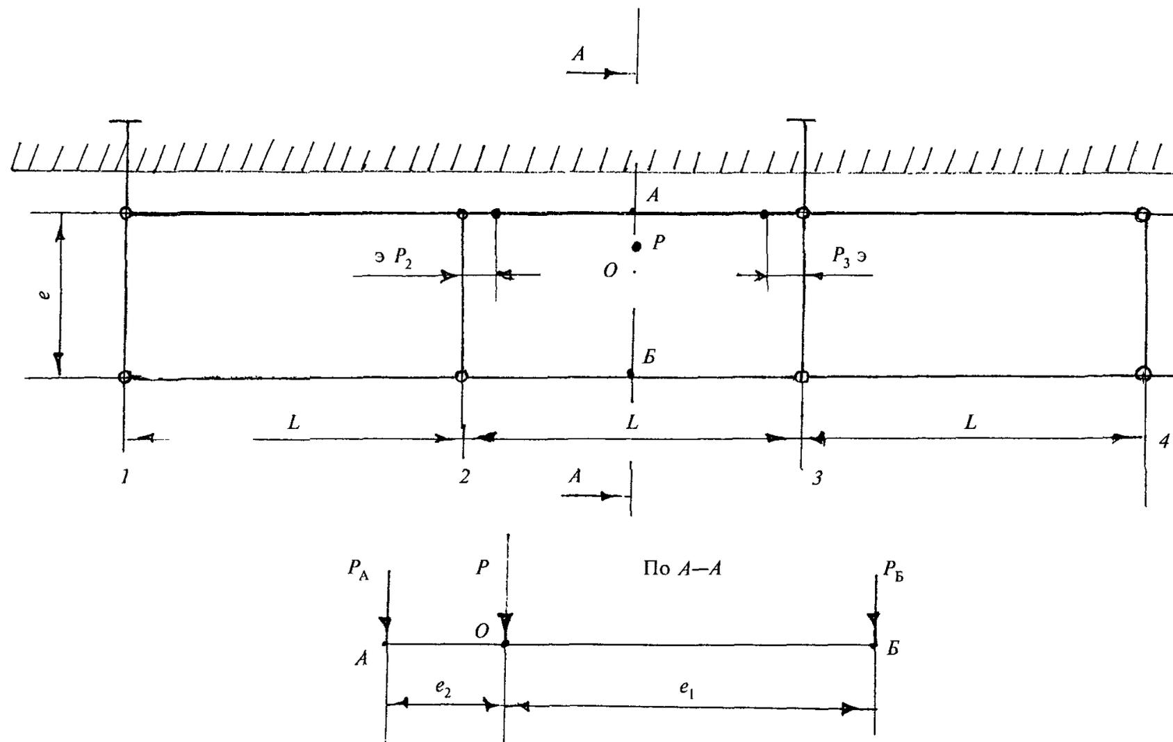
Рисунок 4 — Расчетная схема стоечных приставных лесов
