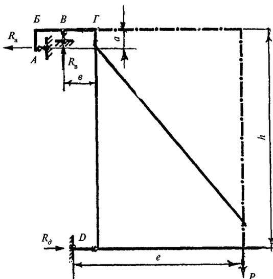
Рисунок 6 — Расчетная схема навесных лесов
