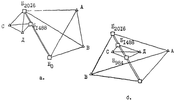
Рис. 2 Схема сети микротриангуляции
