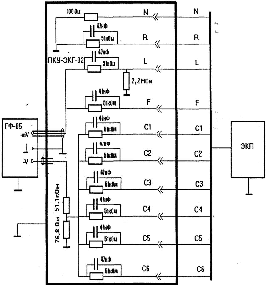
ГФ-05 – генератор функциональный; ПКУ-ЭКГ-02 – поверочное коммутационное устройство; ЭКП – электрокардиоприбор.
