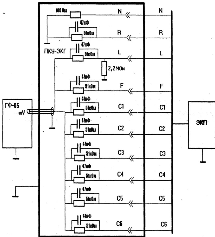
ГФ-05 – генератор функциональный; ПКУ-ЭКГ – поверочное коммутационное устройство;
