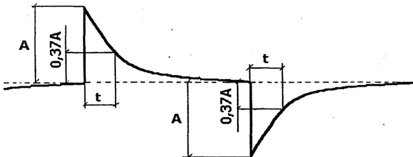
Рисунок 4 - Определение постоянной времени
