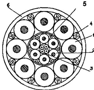
Рис 2 Схема коаксиального кабеля комбинированной конструкции
