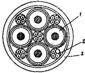
Рис 1 Схема коаксиального кабеля однородной конструкции
