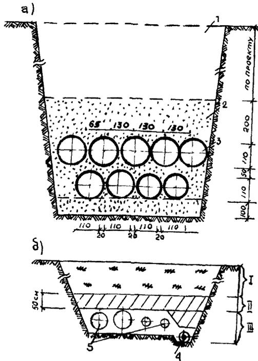
**Рис. 6.3. Схема обратной засыпки траншей:**
