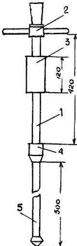
Рис.1. Прибор ДПУ для контроля плотности грунта
