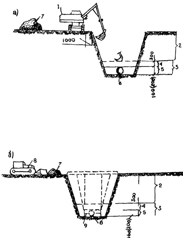
**Рис. 6.2. Схема организации работ по засыпке траншей:**
