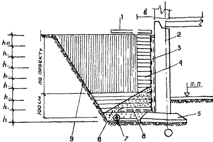
**Рис. 8.1. Схема обратной засыпки пазухи котлована:**
