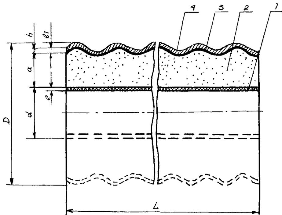
Рис 1 Схема конструкции гибких геопolyизолированных труб "Профлекс":
