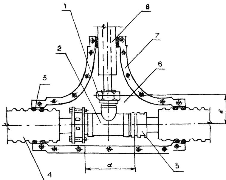
1—соединение компрессионное из латуни (с зажимной накладной гайкой); 2—тройник из металла; 3—резиновые кольца; 4—труба "Профлекс-1"; 5—соединение компрессионное из латуни (с зажимной муфтой); 6—теплоизоляция; 7—оболочка из стеклопластика; 8—плечо отвода для "Профлекс-1"
