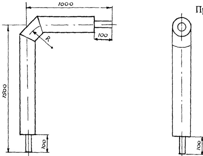
Спецификация теплоизолированных отводов 90° для труб "Профлекс-1"
