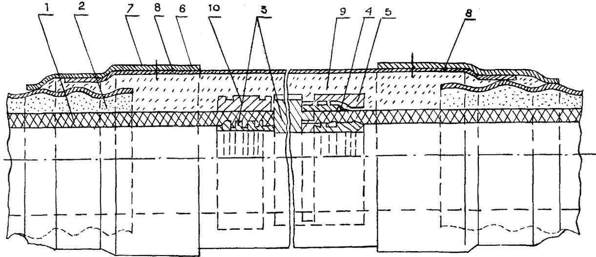
Рис. 3. Основной тип соединения теплоизолированных труб "Профлекс-1":
