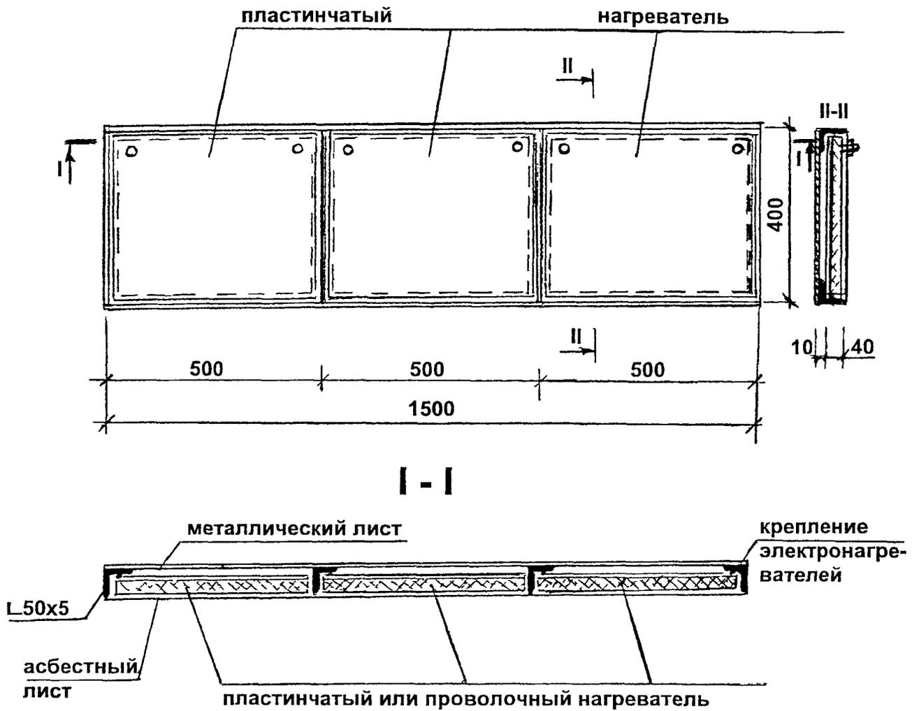
Рис. 12. Расстановка нагревателей на стальных щитах опалубки
