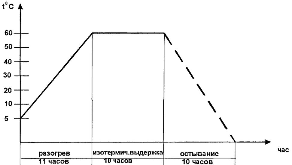
Разогрев бетонной смеси и изотермическая выдержка должны соответствовать приведенным параметрам (табл. 2, 3, 4).
