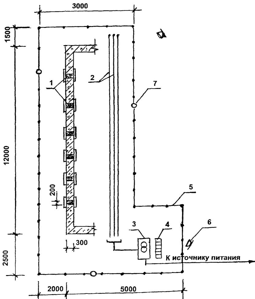
Рис. 4. Схема организации рабочей зоны электрообогрева бетона при замоноличивании стыков греющей опалубкой с пластинчатыми электронагревателями:
