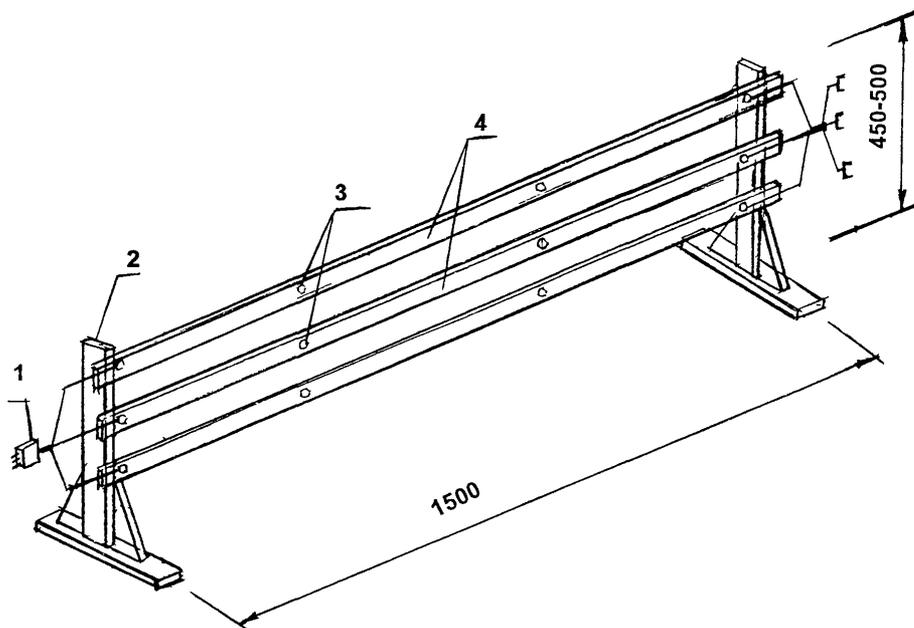
Рис. 1. Инвентарная секция шинопроводов (крайняя секция):
