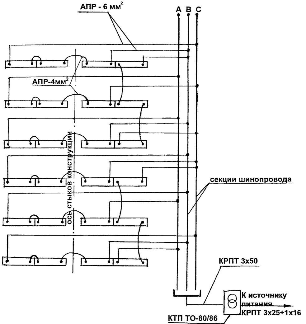
Рис. 7. Электрическая схема электрообогрева бетона при замоноличивании стыков греющей опалубкой с пластинчатыми электронагревателями.
