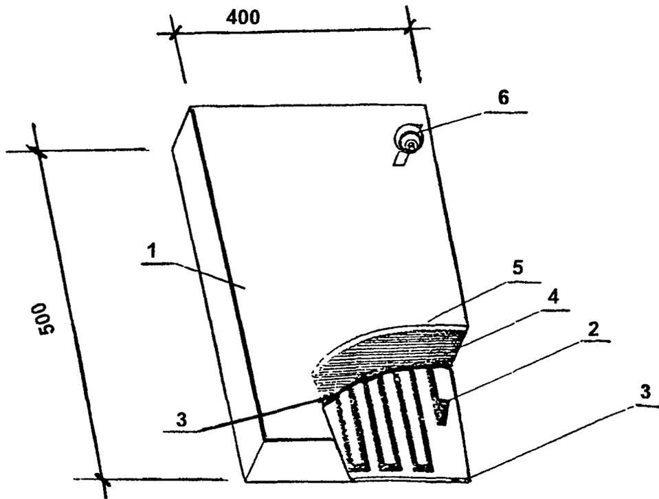
Рис. 13. Секция пластинчатого электронагревателя:
