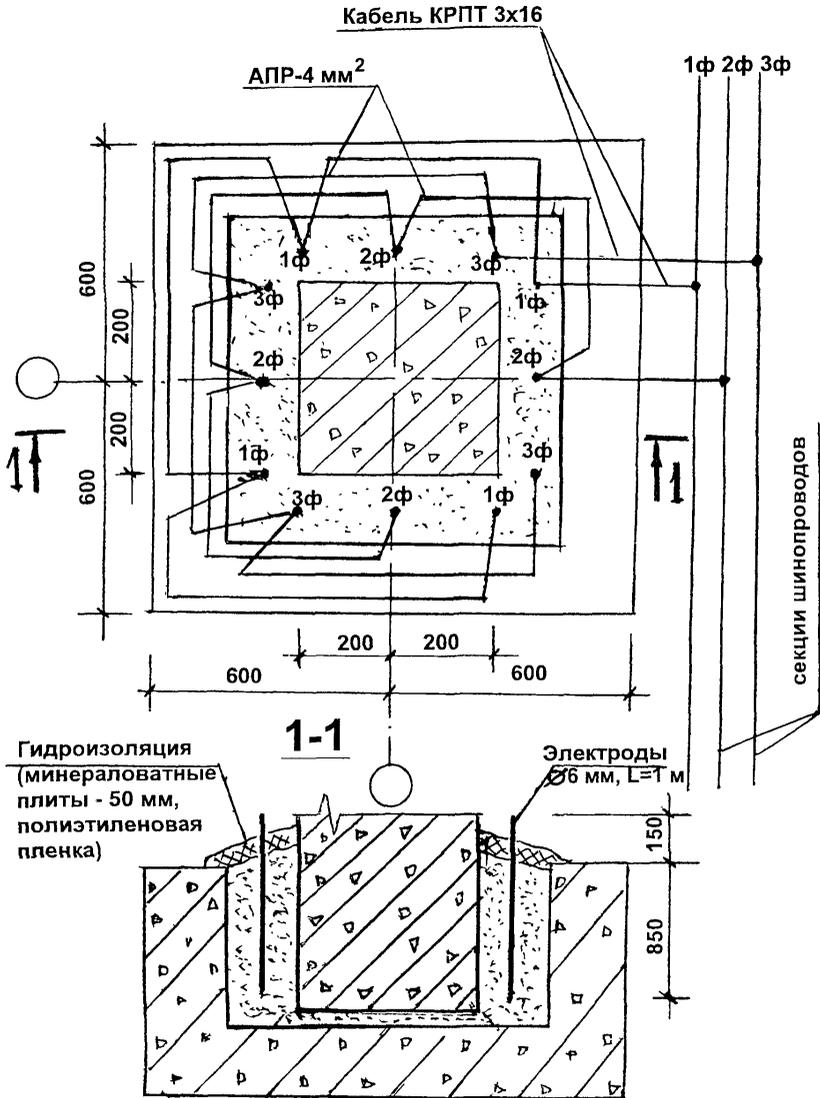
Рис. 8. Схема расстановки электродов при электродном прогреве фундамента с колонной.
