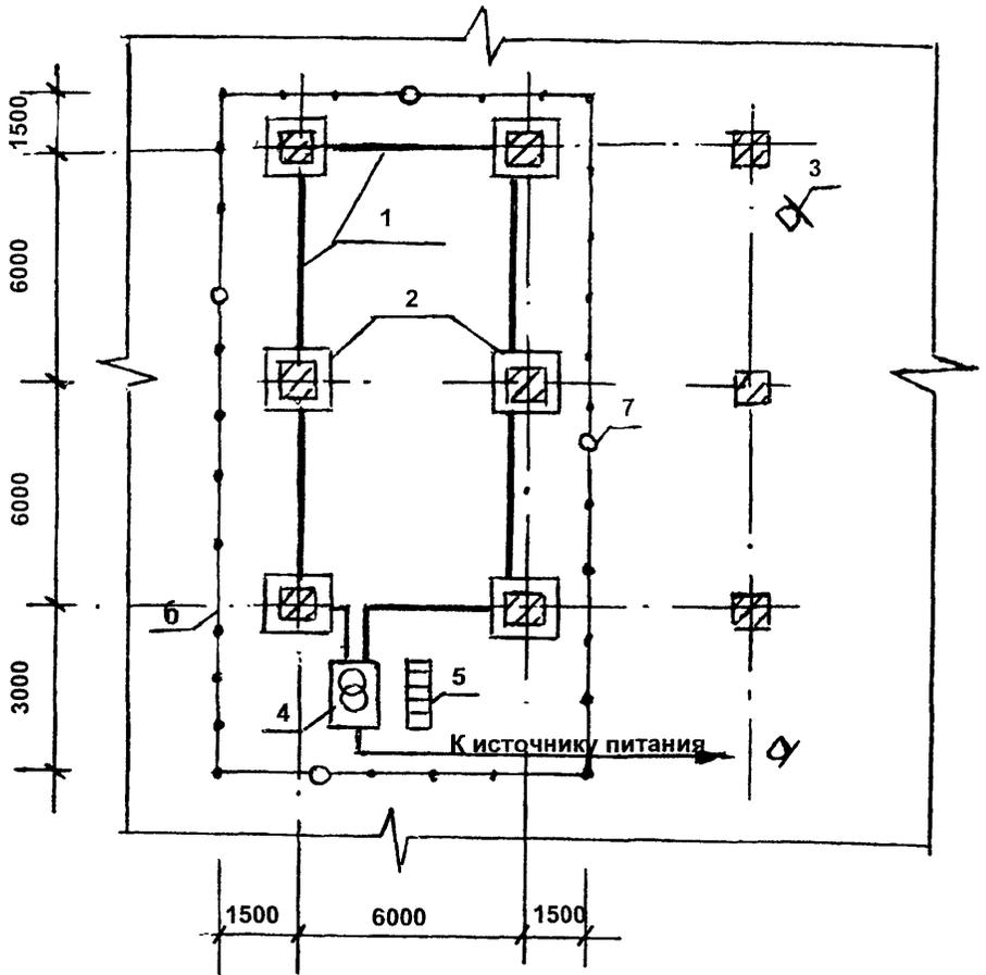
Рис. 3. Схема организации рабочей зоны при индукционном прогреве бетона при замоноличивании стыков:
