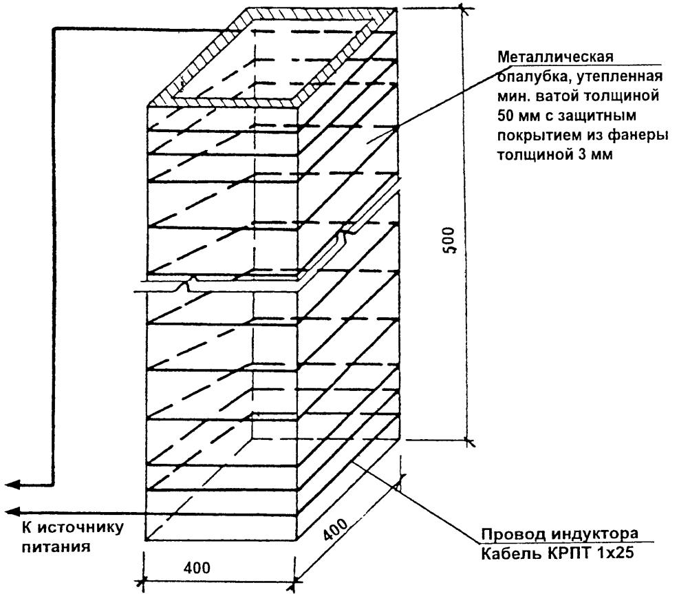
Рис.10. Принципиальная схема индуктора.
