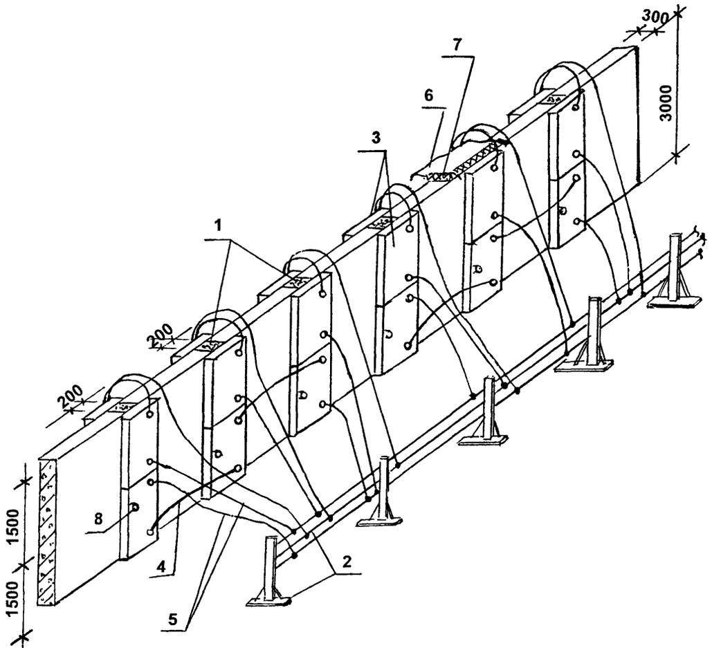
Рис. 15. Обогрев стыков греющей опалубкой с пластинчатыми электронагревателями:
