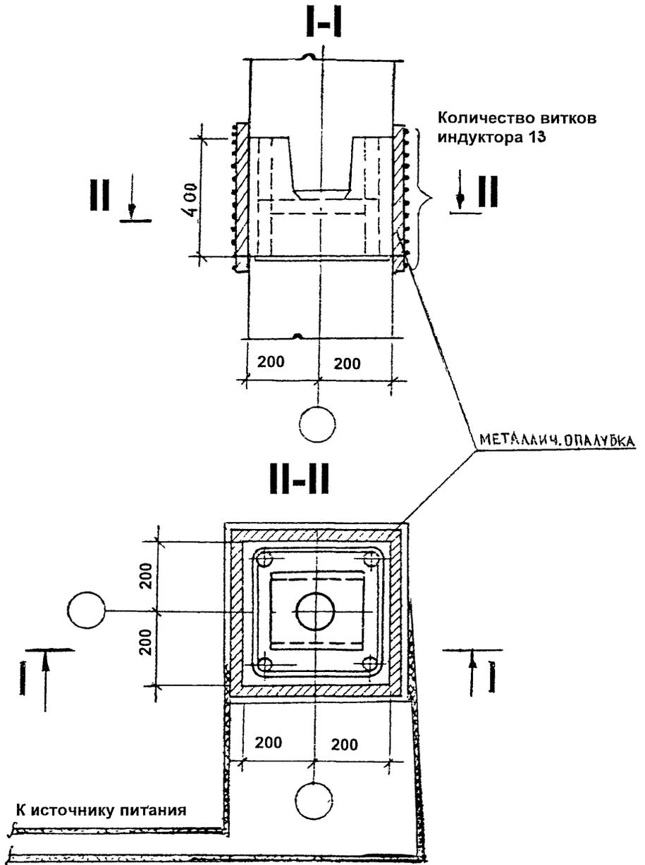
Рис.11. Стык колонны с колонной. Разрезы I-I, II-II.
