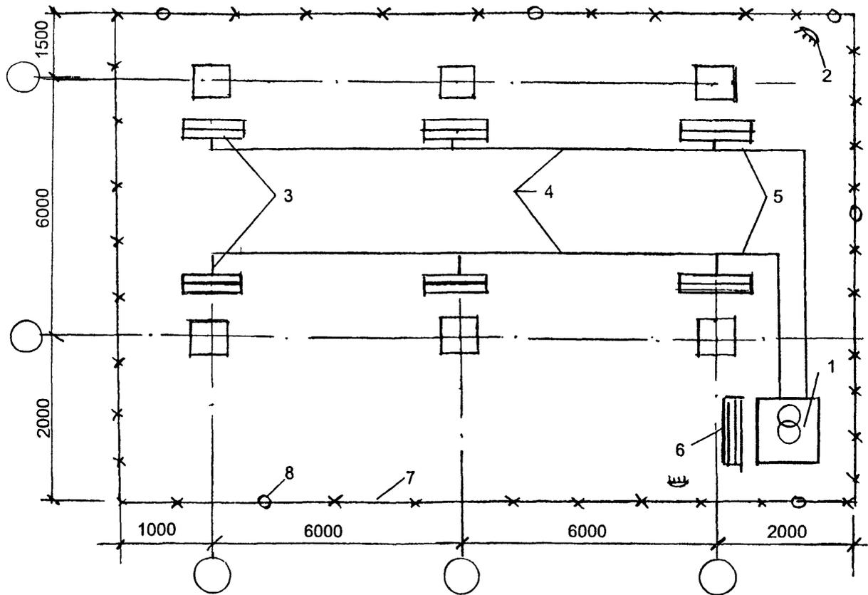
Рис. 2. Схема организации рабочей зоны при электродном прогреве бетона при замоноличивании стыков колонн с фундаментами:
