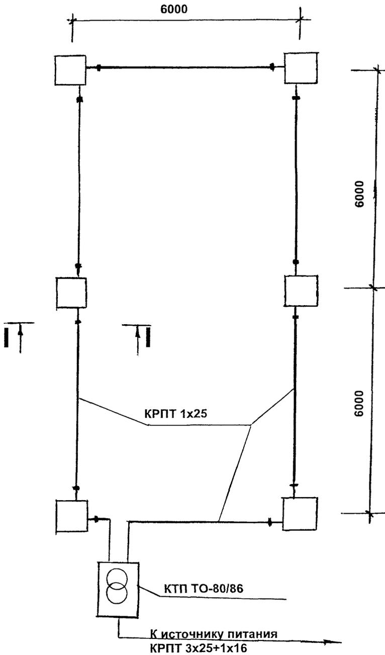
Рис. 6. Электрическая схема индукционного прогрева бетона при замоноличивании стыков.
