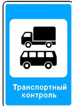
7.14 Пункт контроля международных автомобильных перевозок
