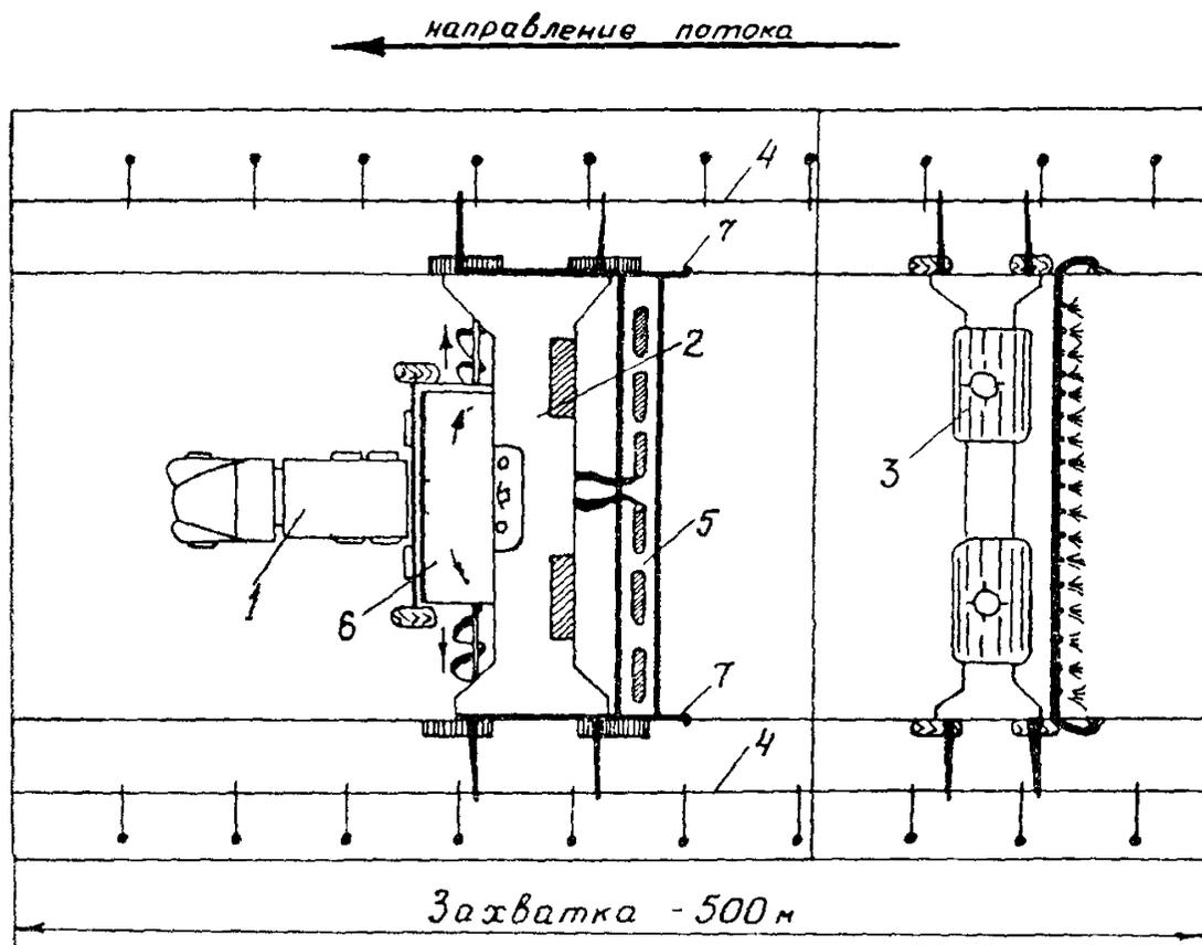
Рис 1 Технологическая схема устройства пескоцементного основания.
