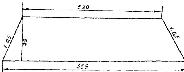
Рис. 4. Поперечное сечение призмы пескоцементной смеси, укладываемой бункером-дозатором
