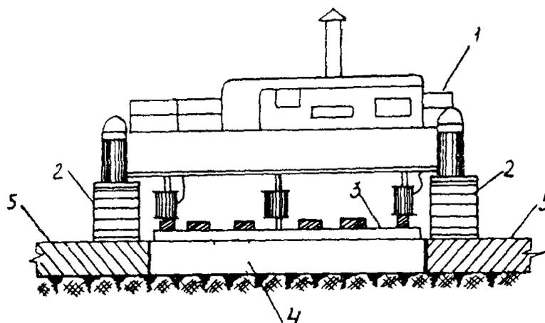
Рис. 2 Схема работы распределителя при укладке пескоцементной смеси на промежуточном ряде:
