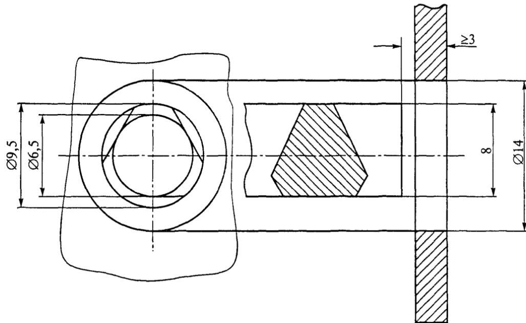
Рис. Треугольная замочная скважина.
