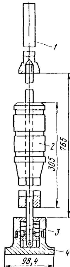
Рис. 7.6 Уплотняющий штамп со штангой и грузом:
