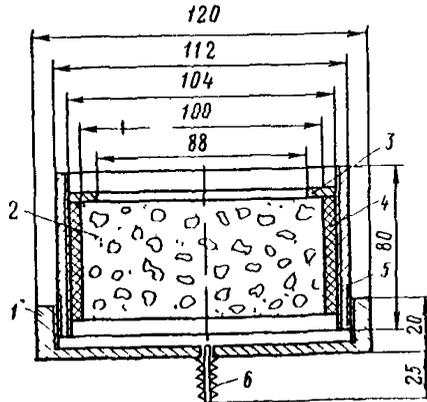
Рис. 7.14. Кювета для испытания асфальтобетонного образца на водопроницаемость:
