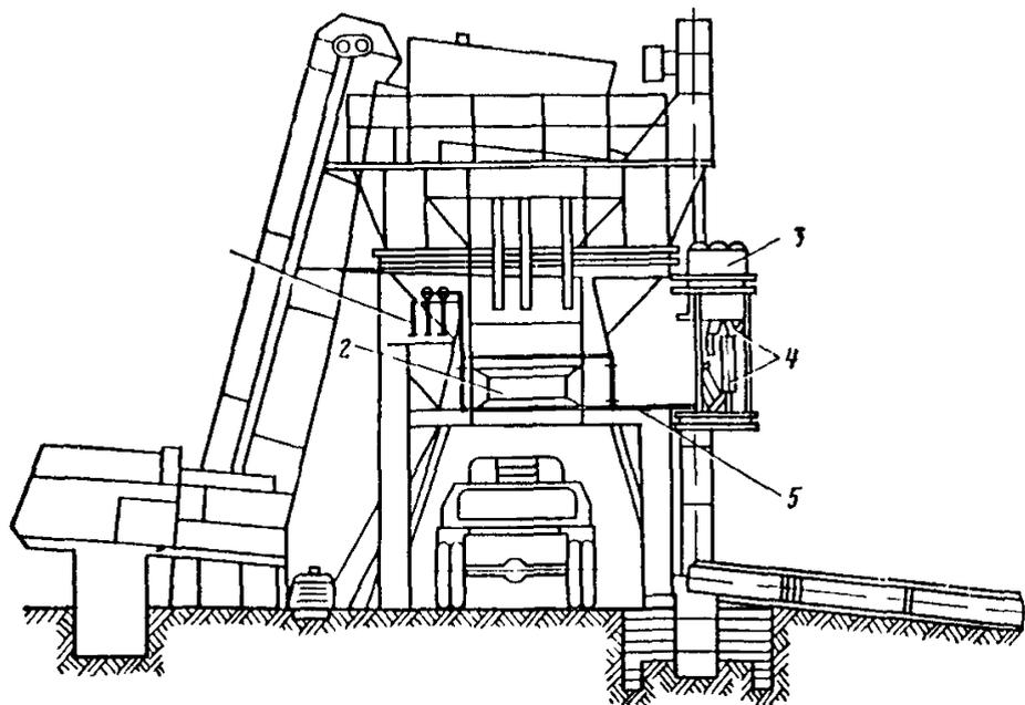
Рис. 5.8. Узел подачи П АВ к смешительному агрегату:
