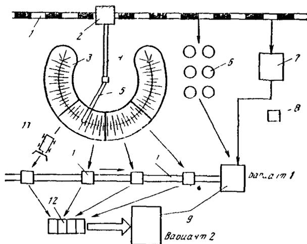
Рис 5.1. Примеры технологических линий приготовления асфальтобетонных смесей. Вариант 1 — размещение асфальтосмесительного оборудования без агрегата питания. Вариант 2 — размещение асфальтосмесительного оборудования с агрегатом питания.
