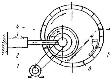
Рис. 7.15. Схема прибора для определения шлифуемости каменных материалов:
