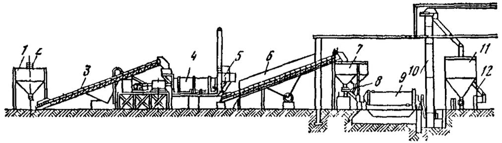
Рис. 5.4. Технологическая схема установки приготовления активированного минерального порошка:
