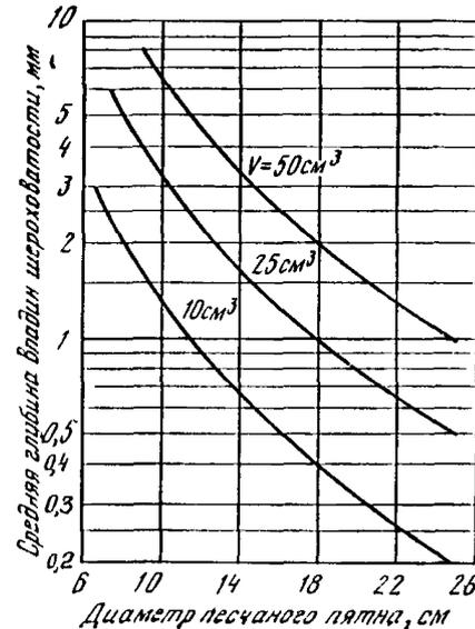
Рис. 7.16. График для определения средней глубины впадины  $h_{\text{ср}}$  шероховатости методом «песчаного пятна»
