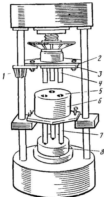
Рис 7.1. Гидравлический пресс с приспособлением для формирования образцов
