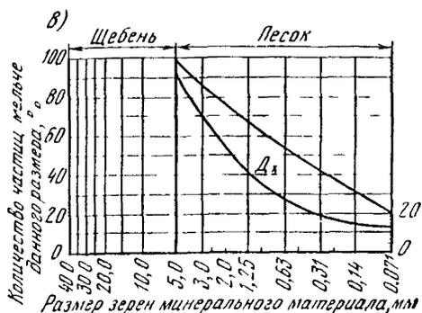
Рис 14 Зерновые составы минеральной части холодных асфальтобетонных смесей
