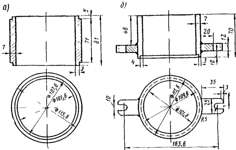
Рис. 7.5. Форма для уплотнения образцов трамбованием с насадкой:
