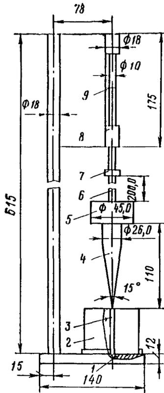
Рис. 7.9. Прибор для определения слеживаемости холодных асфальтобетонных смесей
