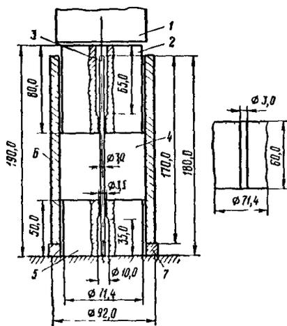
Рис. 7.7. Приспособление для уплотнения образцов при определении слеживаемости холодных асфальтобетонных смесей:
