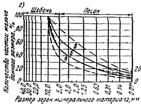
Рис 11. Зерновые составы минеральной части горячих и теплых асфальтобетонных смесей с непрерывной гранулометрией
