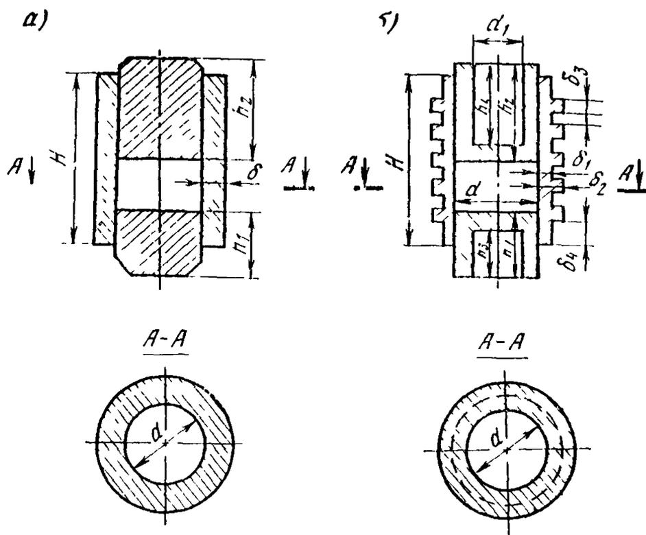
Рис. 7.2. Формы для изготовления образцов
