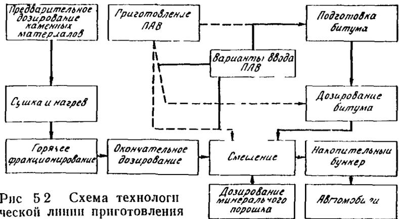
Рис 5.2 Схема технологической линии приготовления асфальтобетонных смесей
