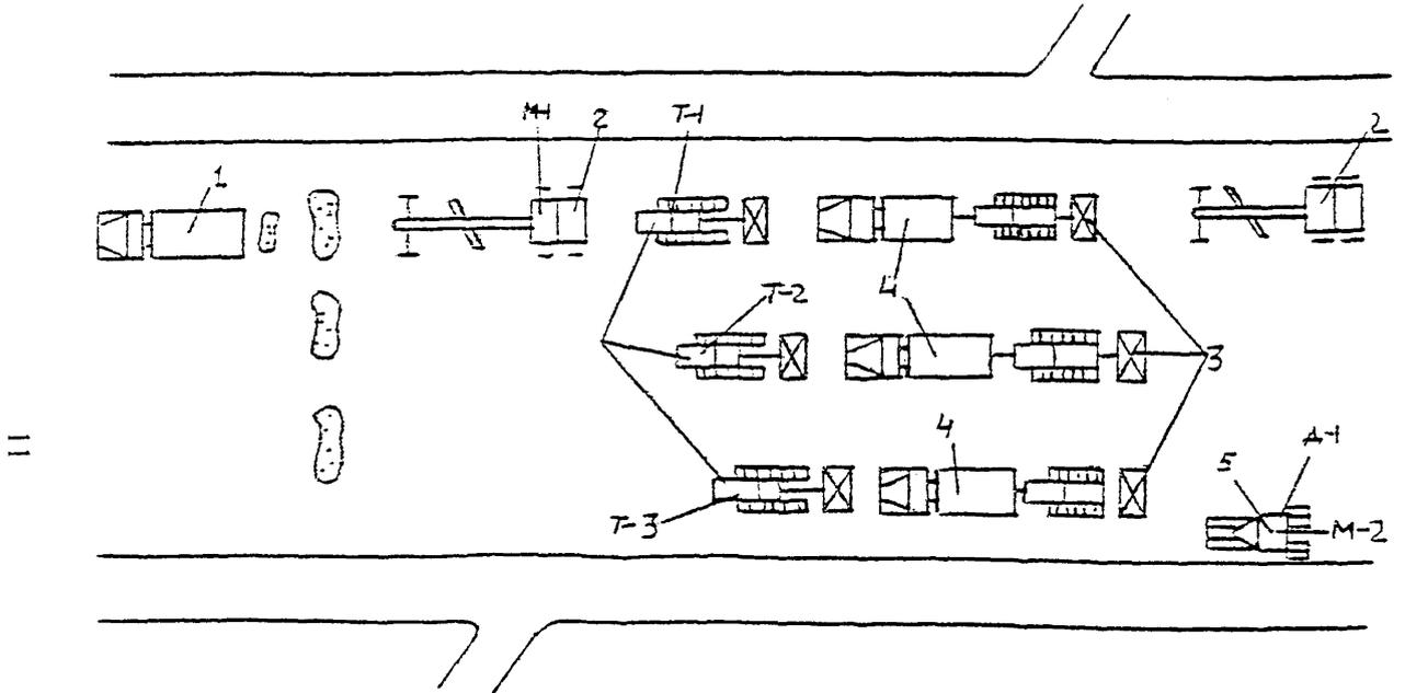
1- автомобиль-самосвал; 2 – автогрейдер; 3 – фреза дорожная; 4 – автобитумовоз; 5 – каток на пневмошинах
