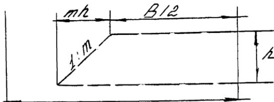
2.4. Забой для грейдер-элеватора целесообразно подготавливать двумя-тремя зарезаниями автогрейдера по одному следу для образования уступа высотой 0,3-0,35м.
