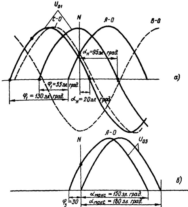
Рис. III.9. Взаимное расположение опорных синусоид в панели ПФ:
