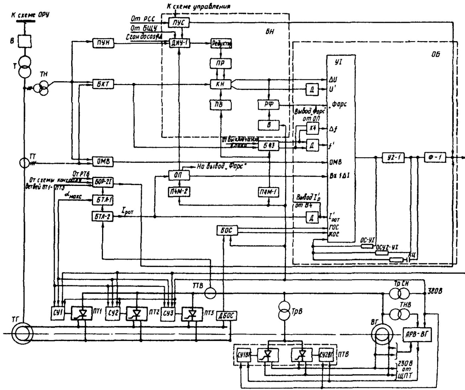
Рис. III. I. Структурная схема тиристорного возбудителя с АРВ турбогенератора ТВВ-800-2:
