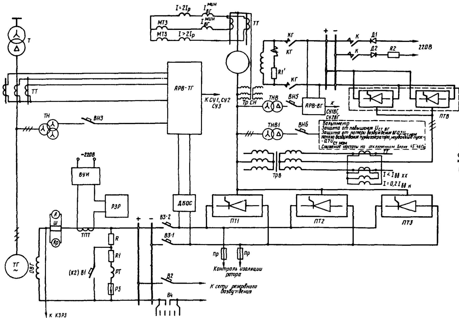
Рис. III.2. Схема силовых цепей тиристорного возбуждения турбогенератора ТВВ-800-2:
