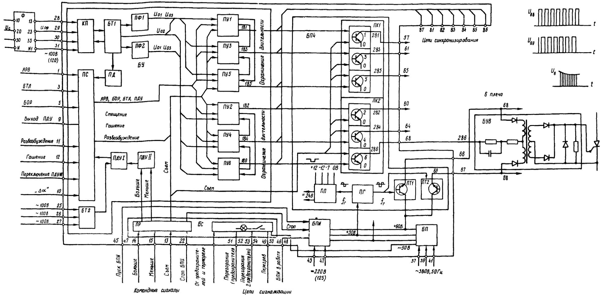
Рис. III.5. Структурная схема системы управления тиристорами:
