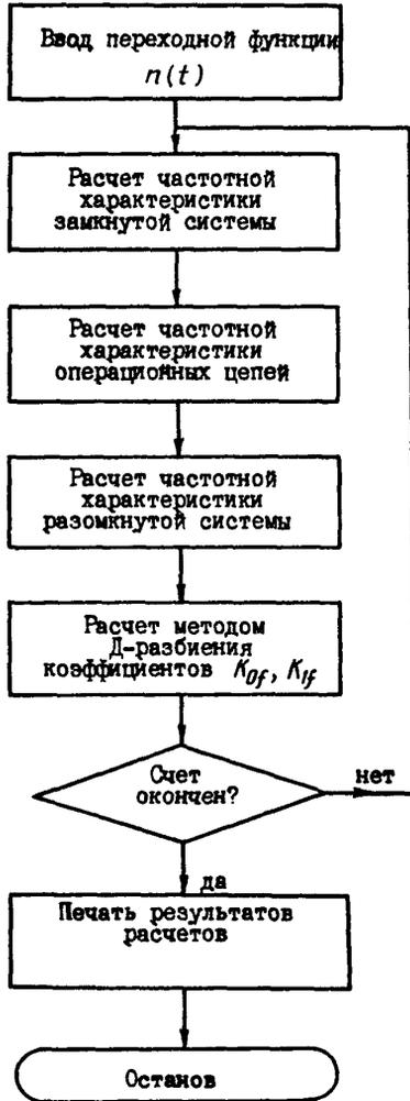
Рис.П2.П. Блок-схема расчета области устойчивости на ЗЕМ
