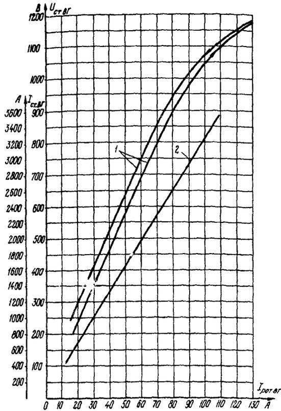
Рис. 1. Характеристики холостого хода и короткого замыкания ВГ для ТВВ-800-2:
