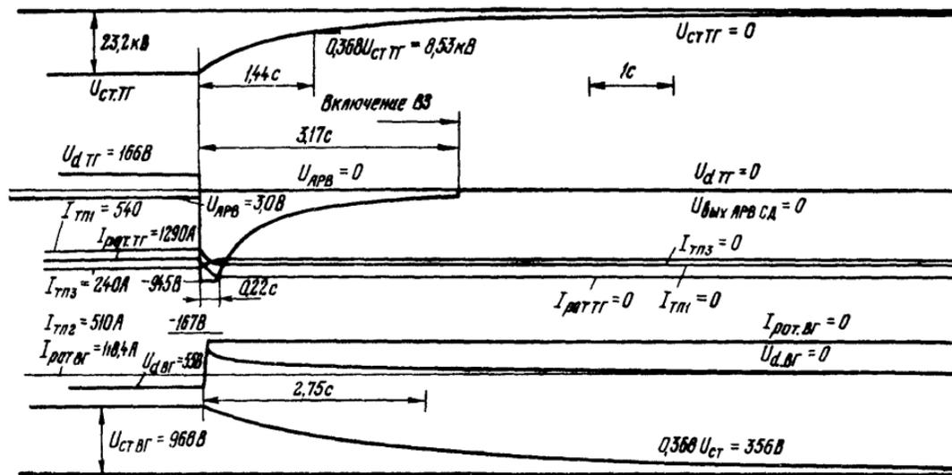
Рис.II. Осциллограмма гашения поля ТВВ-800-2 при работе его на холостом ходу отключением КТ от защиты
