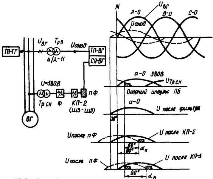
Рис. III.8. Схемы фазировки анодных напряжений, напряжений питания СУ импульсов управления
