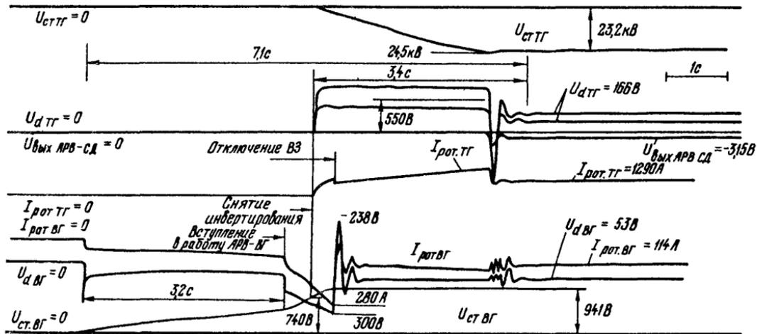
Рис.12. Осциллограмма начального возбуждения ТВВ-800-2 с АРВ-ТТ
