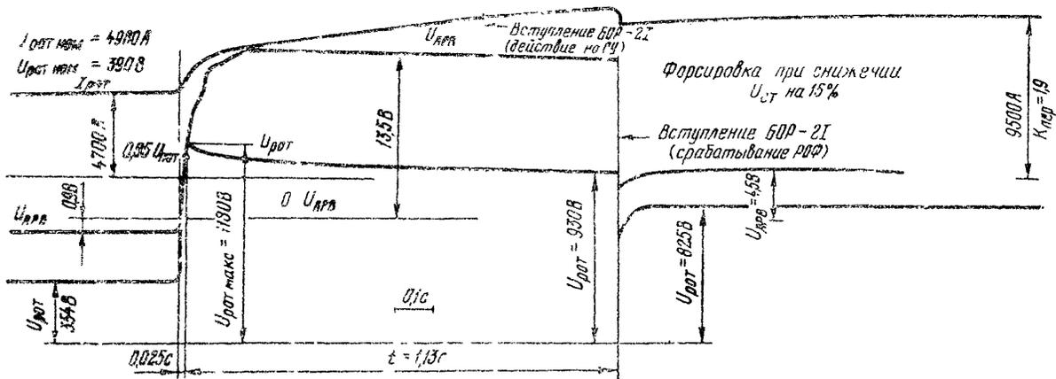
Рис. 16. Опыт форсировки возбуждения при работе ТВР-200-2 в сети
