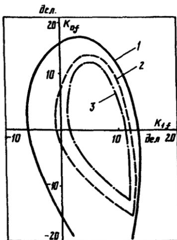
нал отклонения напряжения генератора от заданного значения. Однако при дальнейшем увеличении передаваемой по линии мощности область устойчивости смещается вправо, в сторону положительных значений коэффициента регулирования по производной частоты, и не охватывает начало координат. Регулятор пропорционального типа, в котором отсутствуют каналы регулирования по производным, не может обеспечить устойчивость данных режимов. Нарушение ус-
