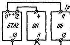
Рис.9. Схема выходного фильтра ОБ и цепей  $I_p'$  в системе самовозбуждения ТТВ-200:
