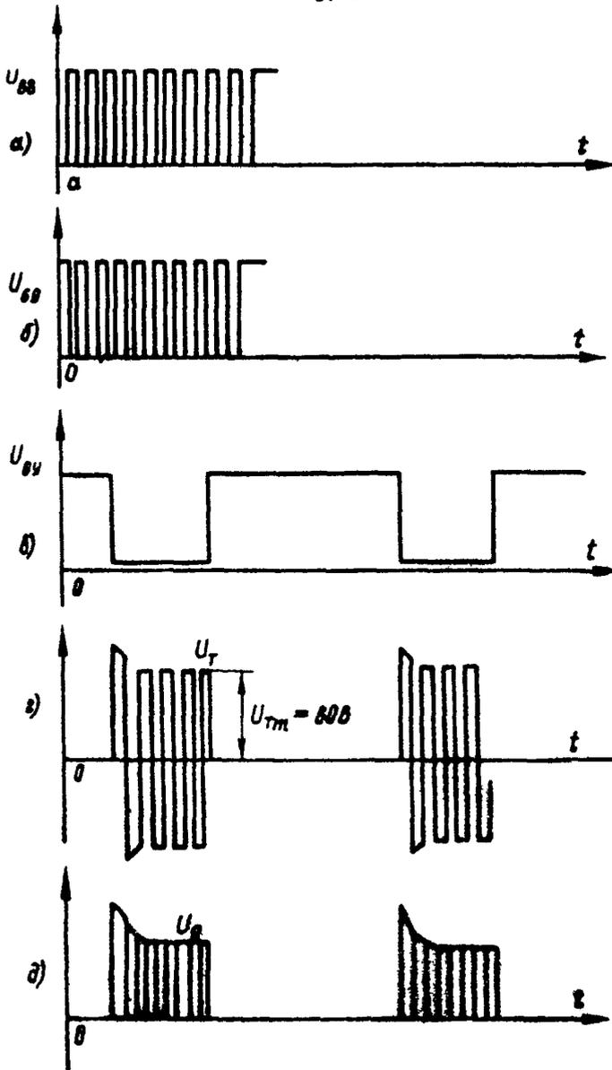
Рис. III. 6. Форма выходных напряжений СВ:
