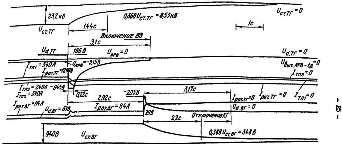
Рис. 10. Осциллограмма гашения поля ТВВ-800-2 при работе его на холостом ходу ключом с БЩ
