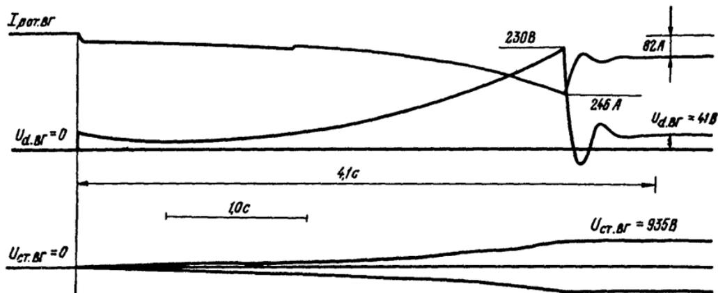
Рис.5. Осциллограмма начального возбуждения ВТ с ПДУ для ТВВ-800-2
