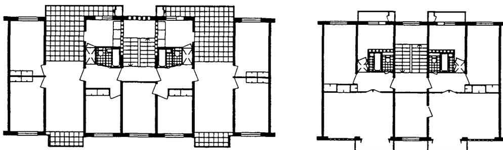
Обеспечение сквозного проветривания объема через квартиры
