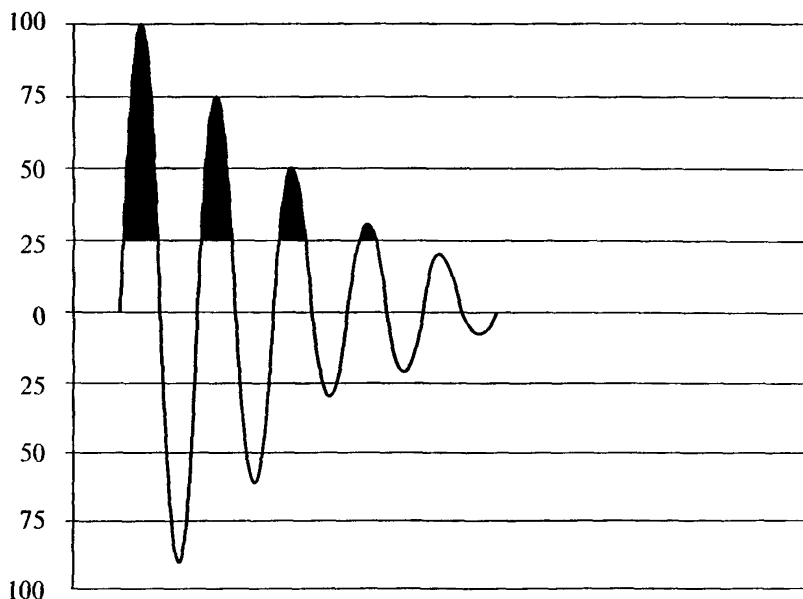
Рис. 9. Определение коэффициента демпфирования преобразователя.
