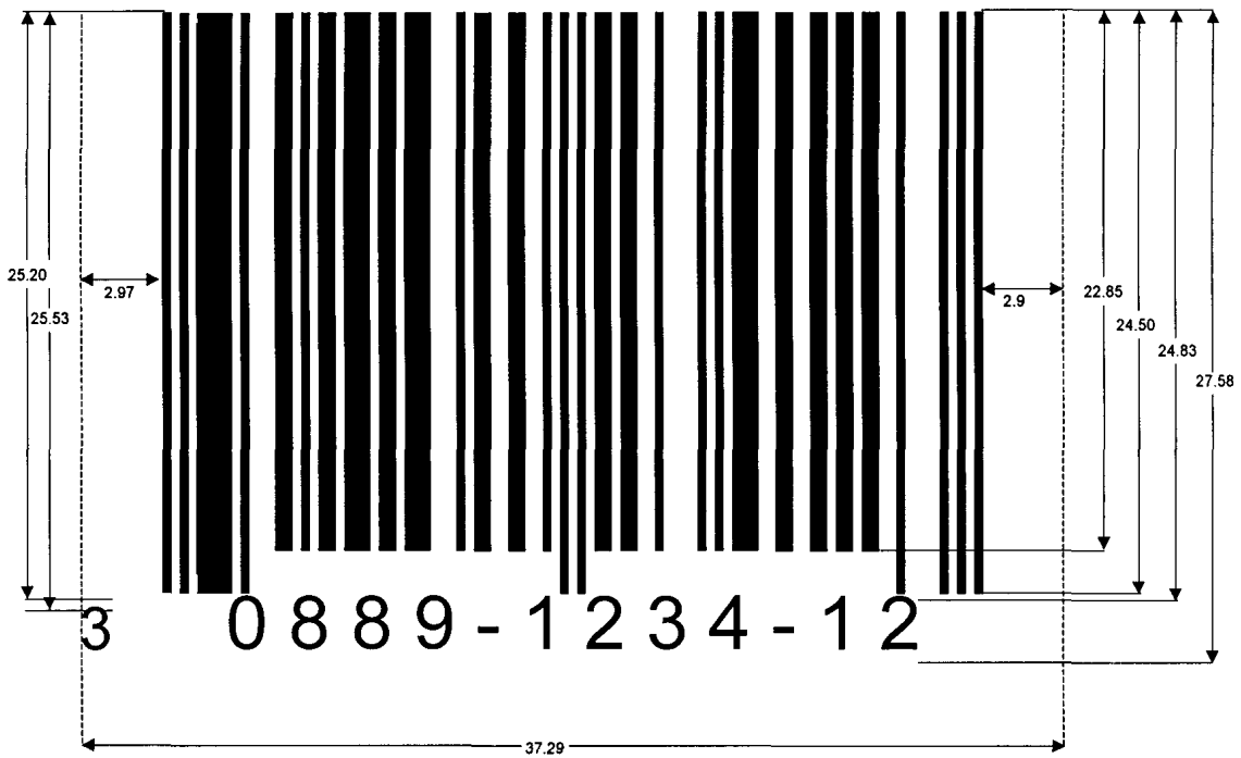
Рисунок Е.3 — Пример вариации символа UPC-A
