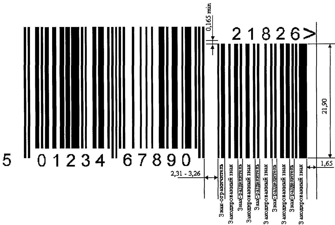
Рисунок Е.7 — Символ EAN-13 с 5-разрядным дополнительным символом
